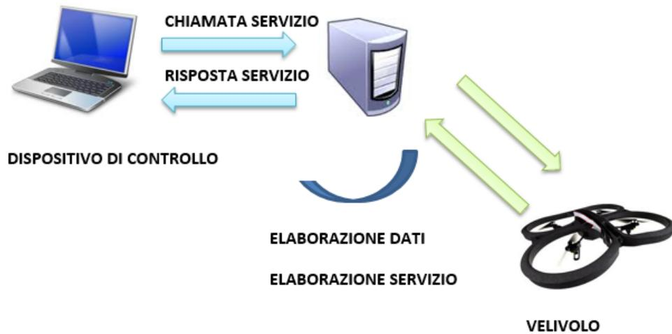
Figura 4.6: Architettura a tre livelli di deployment con elaborazioni servizio e dati eseguite da una macchina server
