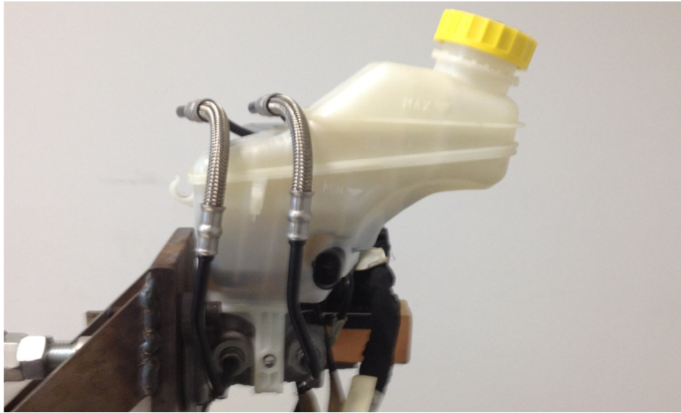
Figura 3.2: Pompa tandem montata su banco comprensiva del serbatoio da cui viene pescato l'olio
