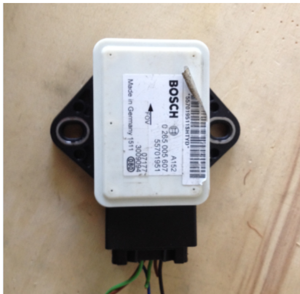
Figura 3.5: Sensore di imbardata di un veicolo Grande Punto 1.2v
