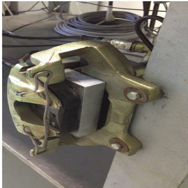
Figura 3.3: Pinze freno montata su banco HiL. Sul banco sono presenti 4 pinze alloggiare sulle 4 gambe del banco.
