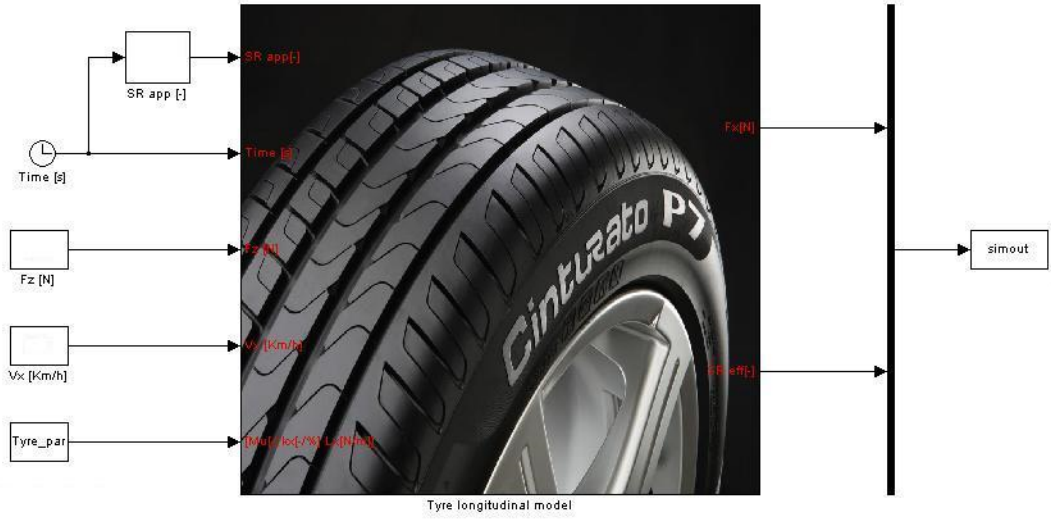
Figura 2.5: Modello di pneumatico fornito da Pirelli Tyre
