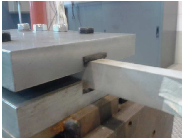
Figura 6.30 Foto della morsa 1 con inserti in gomma posizionati sopra e sotto la catena nella porzione di catena adibita alla modifica del vincolo.
