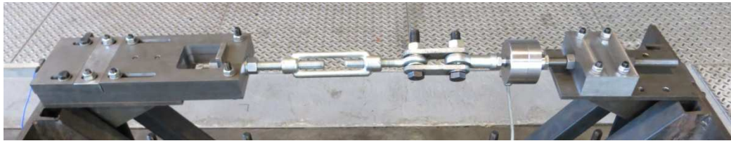
Figura 6.19 Lato carico. Sulla sinistra si trova la morsa 2 collegata da una parte alla catena e dall'altra al lato con tenditore e cella di carico. Sulla destra la morsa 3 chiude il sistema.
