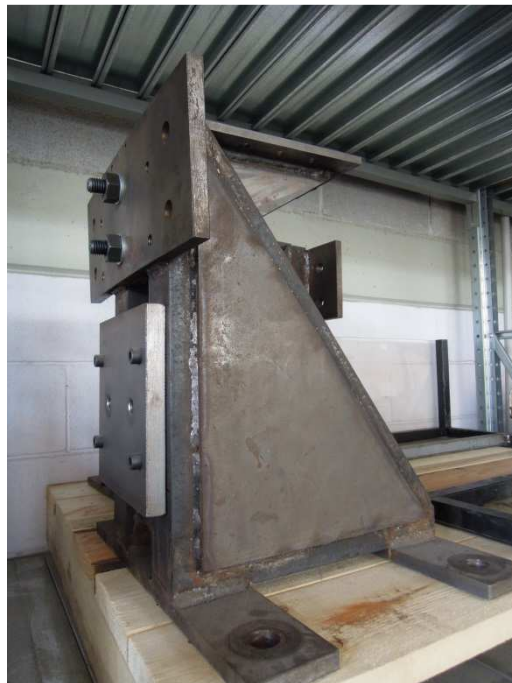
Figura 6.3 Squadra per il fissaggio a terra del sistema realizzato.
