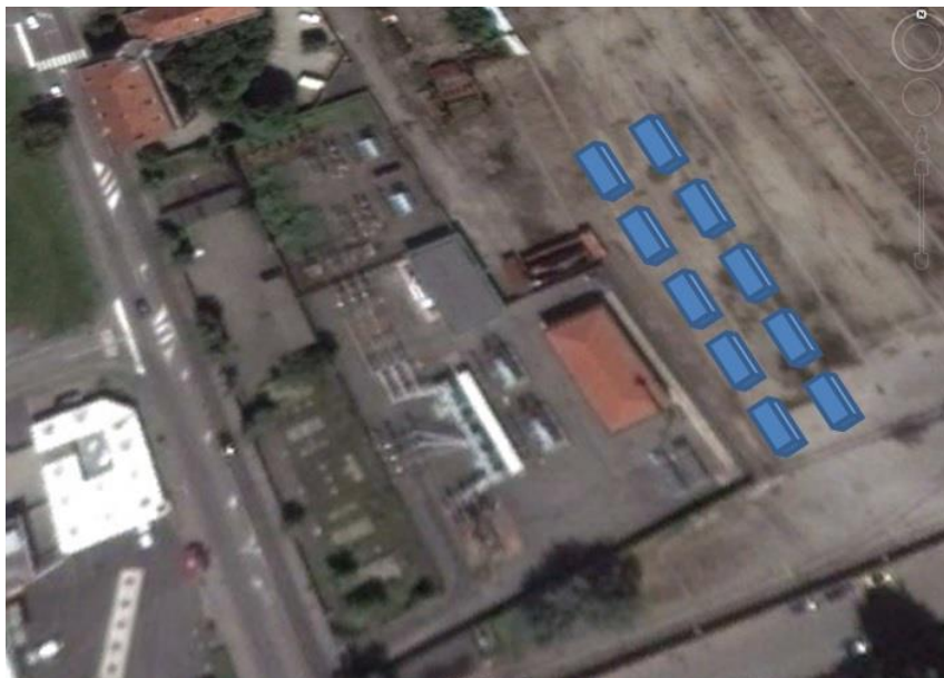
Figura 8.37 – Rappresentazione dell'installazione del sistema di accumulo presso la CP di Legnano
