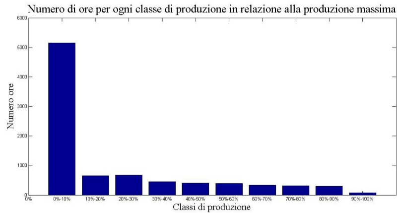
Figura 7.9 - Ripartizioni delle ore nelle classi per la percentuale di potenza erogata in relazione al valore massimo
