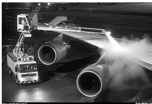
Figura 1.4: Operazione di de-icing a terra prima del decollo
