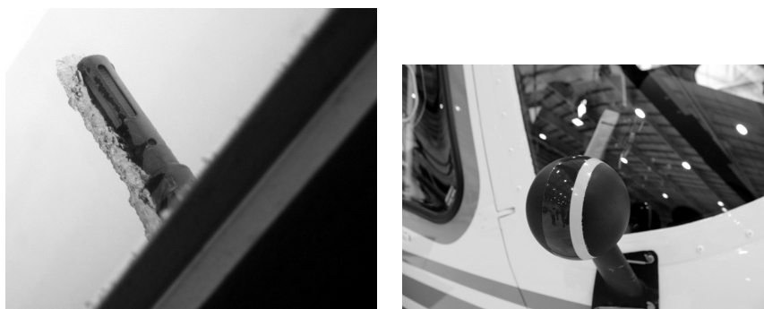
Figura 1.3: Superfici per il controllo visivo della formazione di ghiaccio sulla superficie esterna del velivolo
