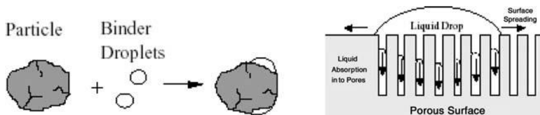
Figura 12 - Bagnatura con distribuzione (fonte: Handbook of Pharmaceutical Granulation Technology )
