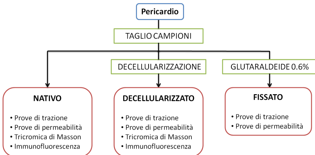
Figura 3.1: Schema a blocchi del flusso di lavoro per la caratterizzazione del pericardio nativo, decellularizzato e fissato. Per ogni gruppo sono indicate le analisi effettuate.
