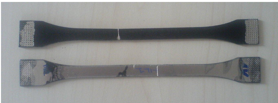
Figura 5.6 Provette al termine della prova di trazione
