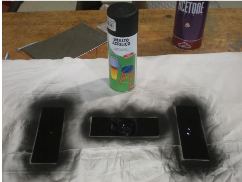
Figura 5.3 Provette al termine della verniciatura
