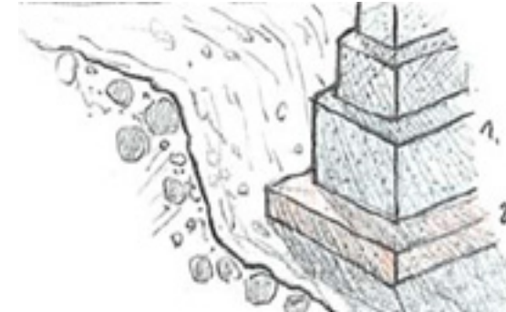
Figura n°19: Sottofondazione con soletta in c.a.
