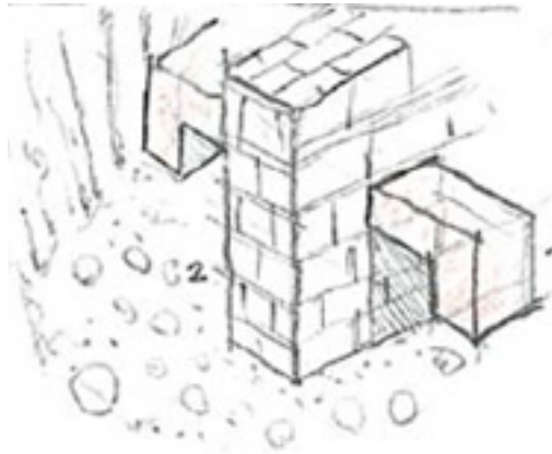
Figura n°18: Ampliamento delle fondazioni per sottomurazione.
