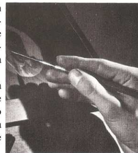
Fig. 2.11. Operazioni di ritocco. (A sinistra). Prima di procedere al ritocco con la matita i negativi devono essere ricoperti con uno strato di vernice protettiva applicata mediante un dito avvolto in un pezzo di lino.
