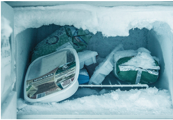
Fig.20 - Depositi di ghiaccio in un modello statico
