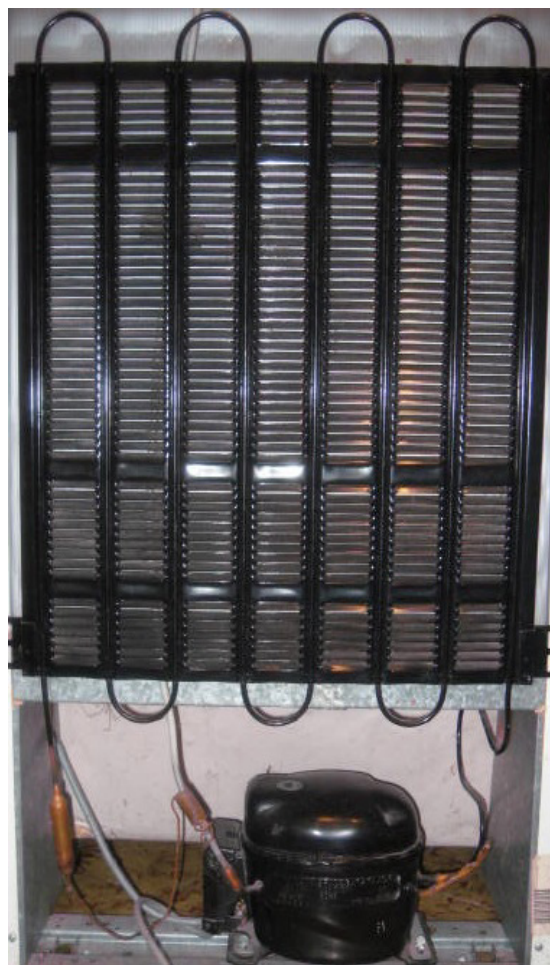
Fig.36 - Condensatore e compressore
