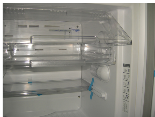
Fig.81 - Allestimento interno, dettaglio chiller trasparente.
