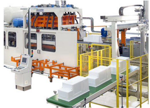
Fig.97 - Impianto termoformatura celle
