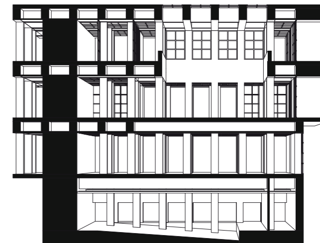
Spaccato prospettico trasversale della corte interna
