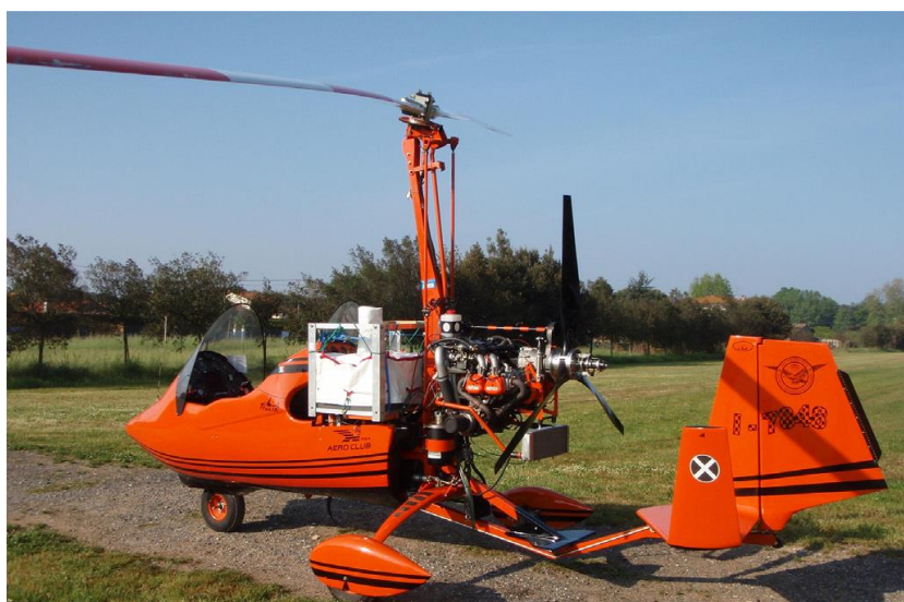
Figura 01.02 L'autogiro utilizzato per rilievi \gamma -spettroscopici
