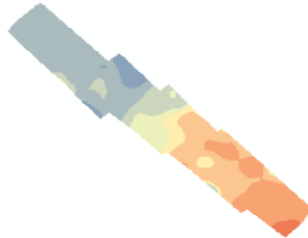
Figura 05.16 Differenze tra DSM D70 Destra e D70 Sinistra sull'area di sovrapposizione
