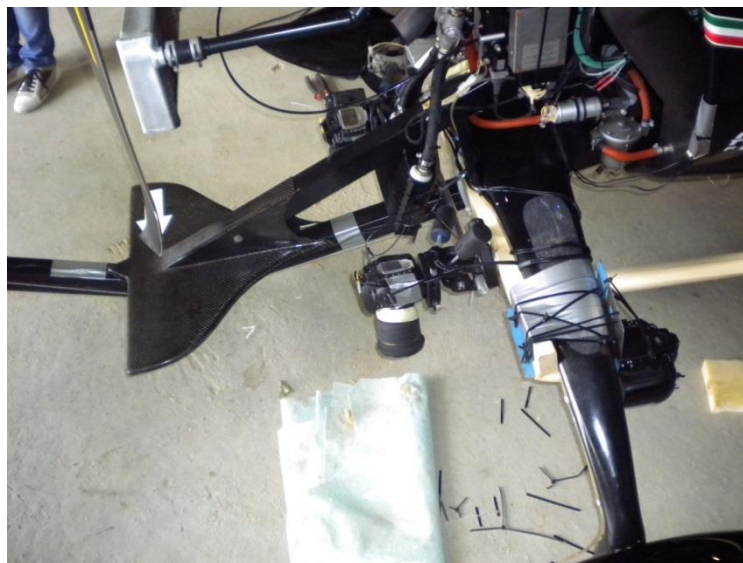
Figura 04.04 Posizione della camera D800® con fisheye rispetto al sistema multicono
