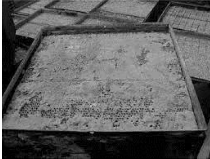
Figura 1.06 - Porzione della matrice rotoria di uno scambiatore Ljungstrom affetta da fenomeni di sporramento.
