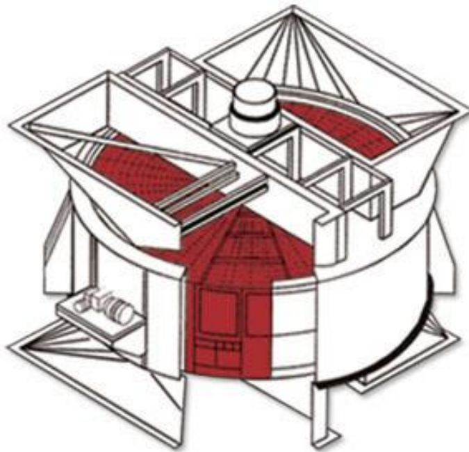
Figura 2.03 – Rappresentazione schematica della struttura completa dello scambiatore, nella quale si vede il rotore montato sull'albero motore ed inserito nell'involucro esterno.
