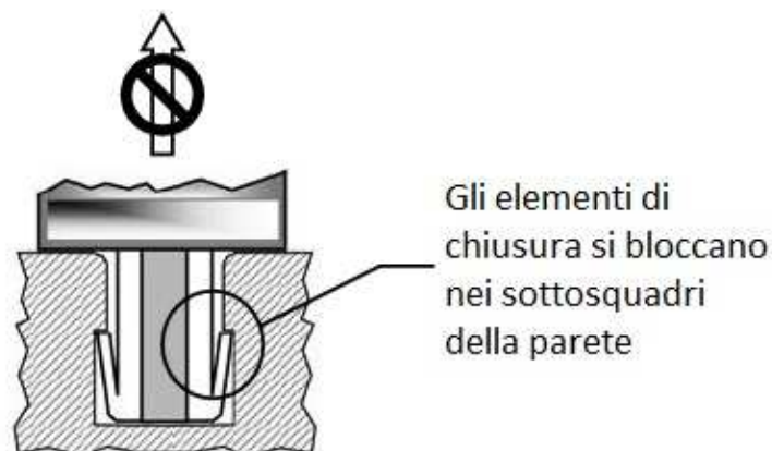
Figura 2-18: Bloccaggio Snap-fit permanente
