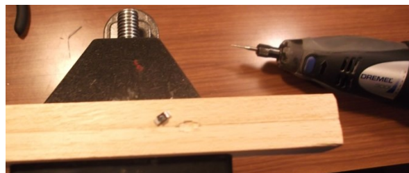
Fig.167a – Alloggiamento del fotodiodo responsabile della misurazione dell'illuminamento interno ai locali. È situato nella parte alta del fermavetro verticale in modo tale da risentire minimamente delle posizioni relative degli utenti all'interno del locale.
