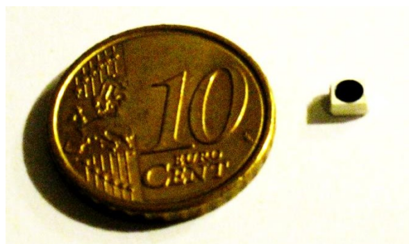
Fig.156 – Fototransistor NIR_picco di sensibilità a 1000 [nm]. I due contatti ( Collettore ed Emettore sono sull'angolo in basso a sinistra e sull'angolo in basso a destra) il connettore che apre e chiude il passaggio della corrente ( Base ) è quel cerchio nero che riesce a valorizzare l'energia radiante ricevuta nella gamma del NIR. Dimensioni (3.4*3*2 [m]). [0.42€ cad.]
