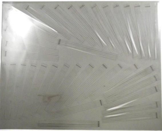
Fig. 082b – Impressione della maschera sul primo filtro che è poi stato tagliato manualmente e ricomposto lungo l'asse verticale.
