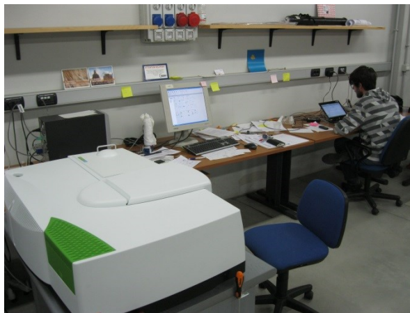
Fig. 066 – In primo piano, spettrofotometro Lambda 950; in secondo piano, calcolatore elettronico per l'acquisizione e rielaborazione dei dati.
