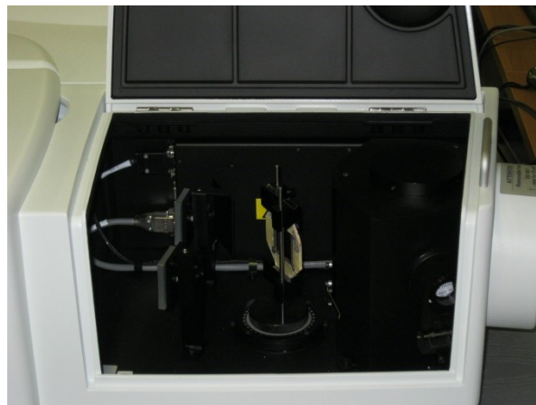
Fig. 069 – Il mio provino è alloggiato sul supporto centrale girevole; sono state effettuate anche misurazioni di trasmissione diffusa+diretta a ridosso della sfera (sulla sinistra del corpo nero) e misurazioni di riflettanza (quasi normale) posizionando il provino entro quel tappo bianco che si vede a destra dell'immagine.
