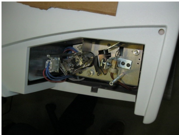
Fig. 067 – Alloggiamento delle sorgenti luminose: lampada al tungsteno (a sinistra) e sorgente al deuterio (a destra).
