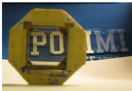
Fig. 097_a-b-c - Trasmissione di due filtri WGF-HTN sovrapposti con fondale sovraesposto per simulare le condizioni di illuminazione ambientale esterne diurne. Si propongono 3 situazioni tra quali differisce unicamente l'angolo \theta tra l'asse di polarizzazione del primo e del secondo filtro.
