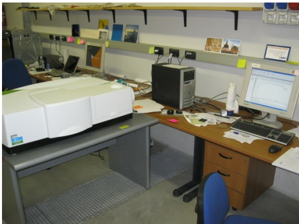
Fig. 098 – Postazione utilizzata per le misurazioni strumentali dei provini WGF-HTN tramite spettrofotometro della “Perkin Elmer” modello “Lambda 950”.
