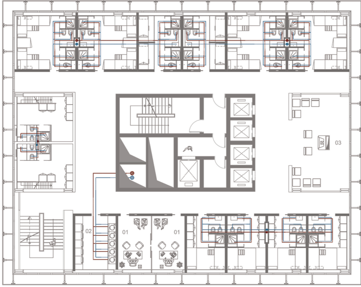
IMPIANTO DI CLIMATIZZAZIONE (HOTEL LOW COST) Sc.1:250
