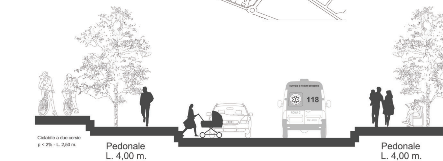
SEZIONE STRADALE SCALA 1:250
