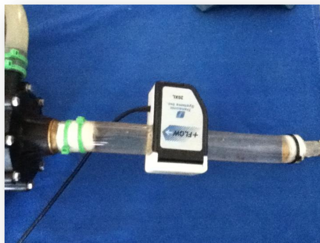
Figura.2.3: Il flussimetro è posizionato a cavallo del tubo in ingresso alla pompa centrifuga in modo che la freccia riportata sul flussimetro indichi il verso del fluido.
