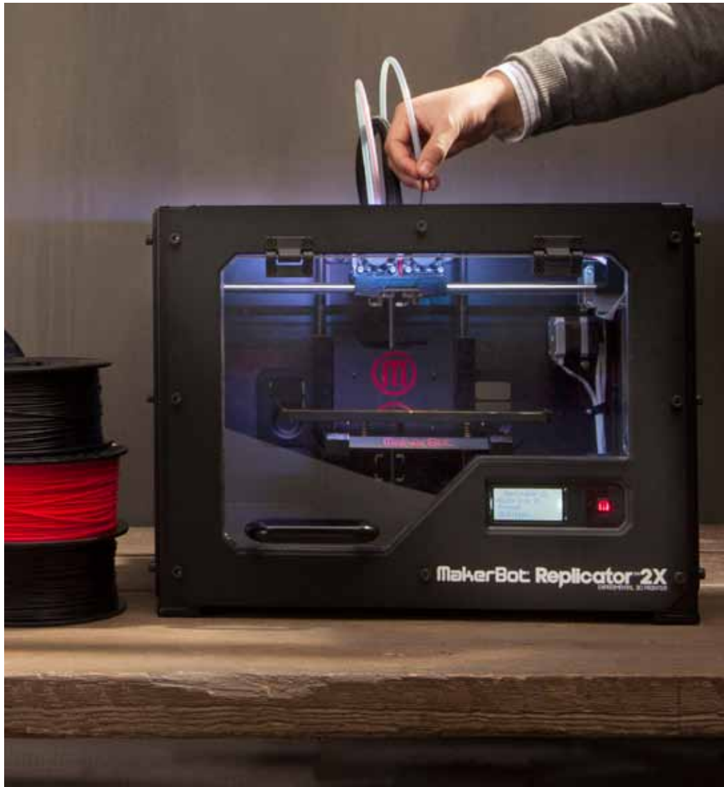
MakerBot Replicator 2X modello più recente con doppio estrusore, Settembre 2012
