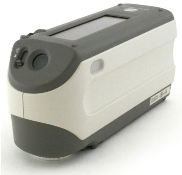
fig. 3.3 Spettrofotometro Konica Minolta CM2600d
