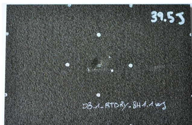
Figura 9: Provino con indicatori di misurazione
