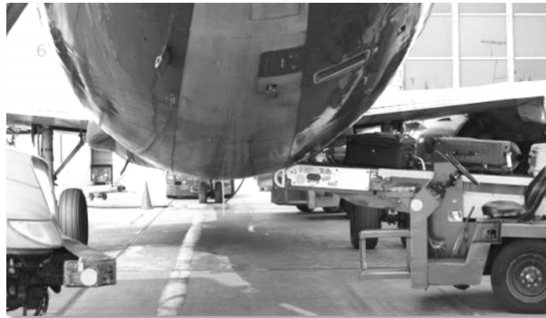
Figura 5: Danni da impatto durante le fasi di carico e scarico merci [5]
