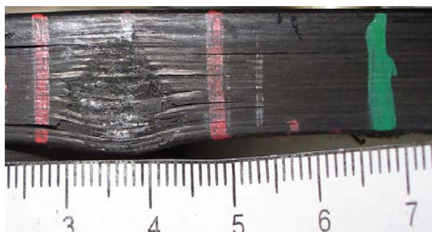
Figura 2: Delaminazione post impatto [1]
