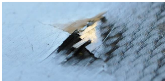
Figura 21: Danno da impatto ( E_{\text{impatto}} = 39.5 \text{ J} )
