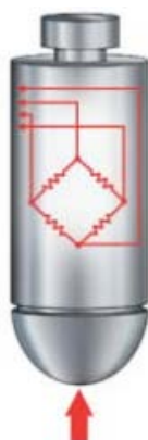
Figura 17: Schema del trasduttore di forza Fractovis
