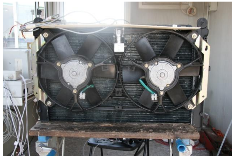
Figura 9: posizionamento relativo del gruppo ventola-radiatore
