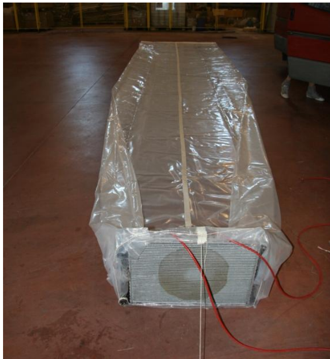
Figura 11: tubo di flusso per la prova di portata
