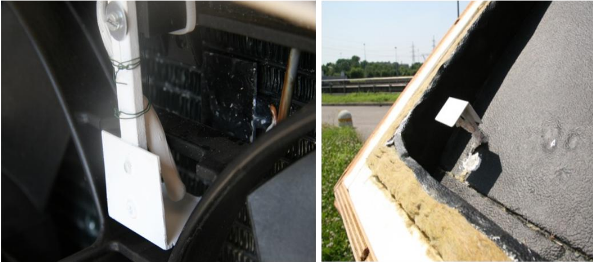
Figura 13: a sinistra sensore di temperatura dell'aria in uscita dal radiatore, a destra sensore di temperatura dell'angolo basso
