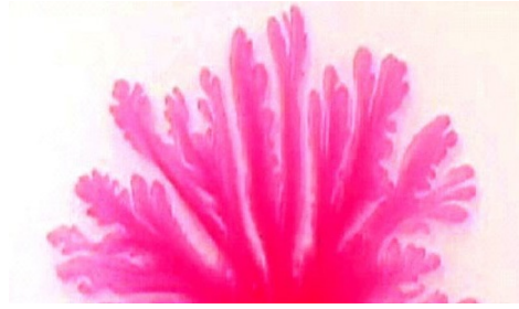
Figura 1.1: Viscous fingering provocato dall'iniezione di cherosene in olio minerale ([1])
