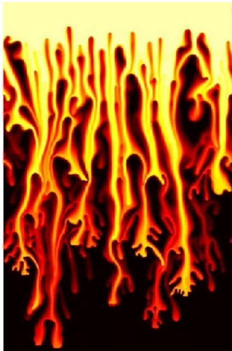
Figura 1.3: Instabilità gravitazionale in una cella di Hele-Shaw ([1])
