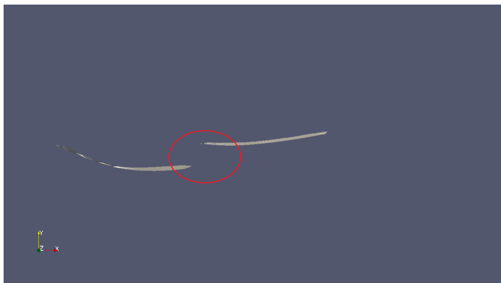
Figura 4.7: Particolare dello spazio tra focce e randa; vista da un piano perpendicolare all'asse z e passante per il Centro Velico
