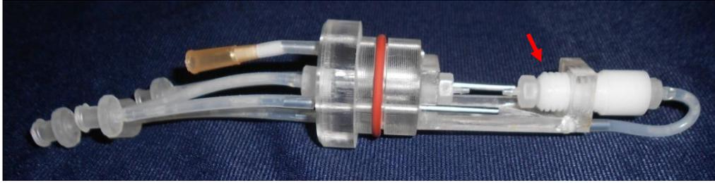
**Figura 3.7.** Fotografia di un esemplare di prototipo 1 realizzato. Si può notare il telaio portavaso nel quale è avvitato l'elemento a vite in POM (indicato con la freccia) che permette l'avvicinamento/allontanamento dei connettori su cui calzare la struttura tubolare.
