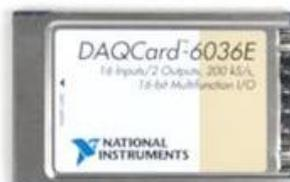
**Figura 3.15.** Scheda di acquisizione NI 6036E (National Instruments®).
