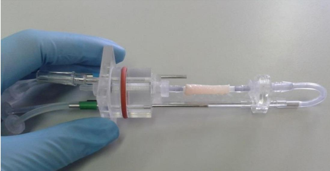
**Figura 4.8.** Campione di arteria mammaria interna porcina calzato sulla guaina siliconica e montato tra i due connettori del telaio portavaso del bioreattore.
