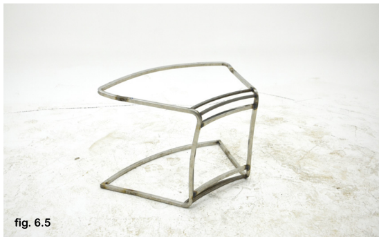
figura 6.5 La struttura in acciaio inox del pouf, prima della fase di bagno e pittura elettrostatica.
