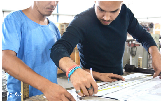
figura 6.3 Fase di studio dimensionale del prototipo su base al disegno tecnico in scala reale realizzato al computer: in questa fase si controlla che il prototipo rispetti le curve e gli aspetti dimensionali studiati al computer.
