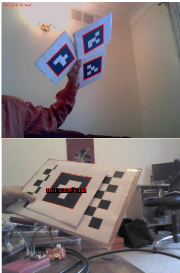
Figura 5.5: Esempio di rilevazione di marker. A destra si vede che ne può rilevare 3. A sinistra come stampa le informazioni su id e coordinate
