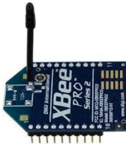
Figura 5.26: Modulo XBee Pro Serie 2 per la comunicazione wireless
