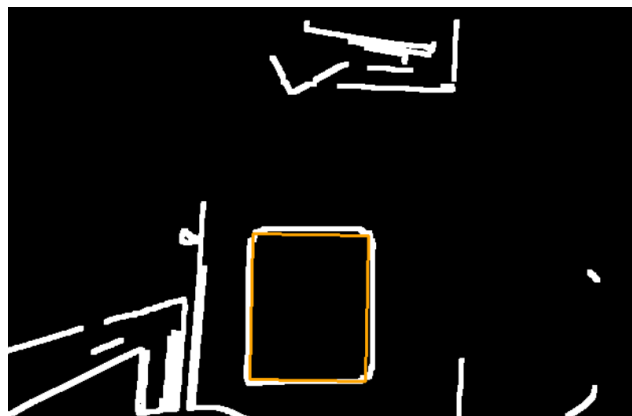
Figura 5.3: Blob detection di un rettangolo evidenziato in giallo nella figura
