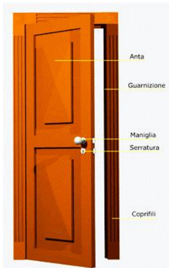
Figura 43 Schema 3D Porta [Arredare e Costruire]
