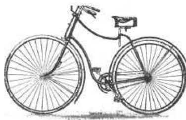
Figura 1.10: Safety bicycle (bicicletta di sicurezza), Starley 1885
