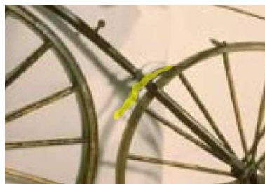
Figura 1.6: Meccanismo di frenata per mezzo di un piccolo cucchiaio
