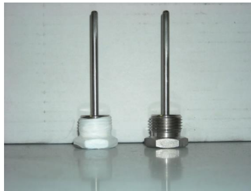
Figura 3.5 - Pozzetti nei quali sono inserite le termoresistenze
