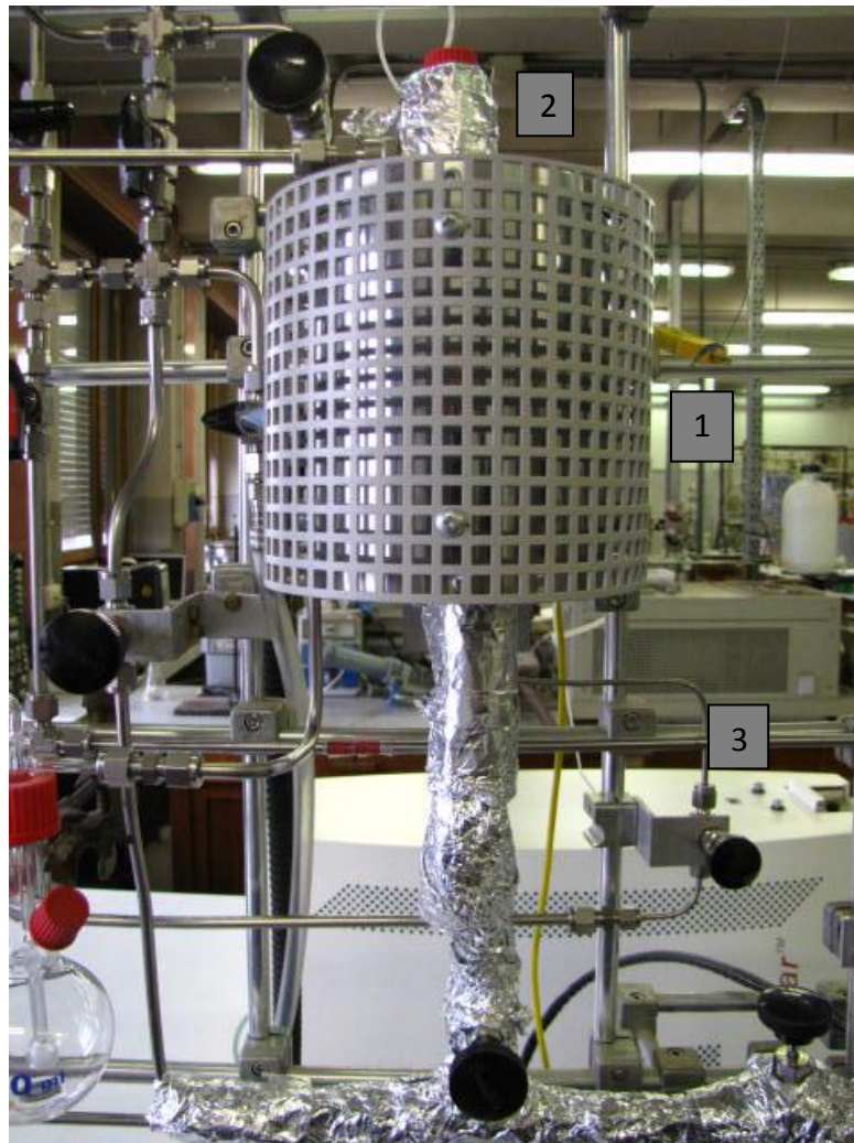
Figura 2.9 (1) Forno (2) contenente del reattore e (3) sistema di raffreddamento
