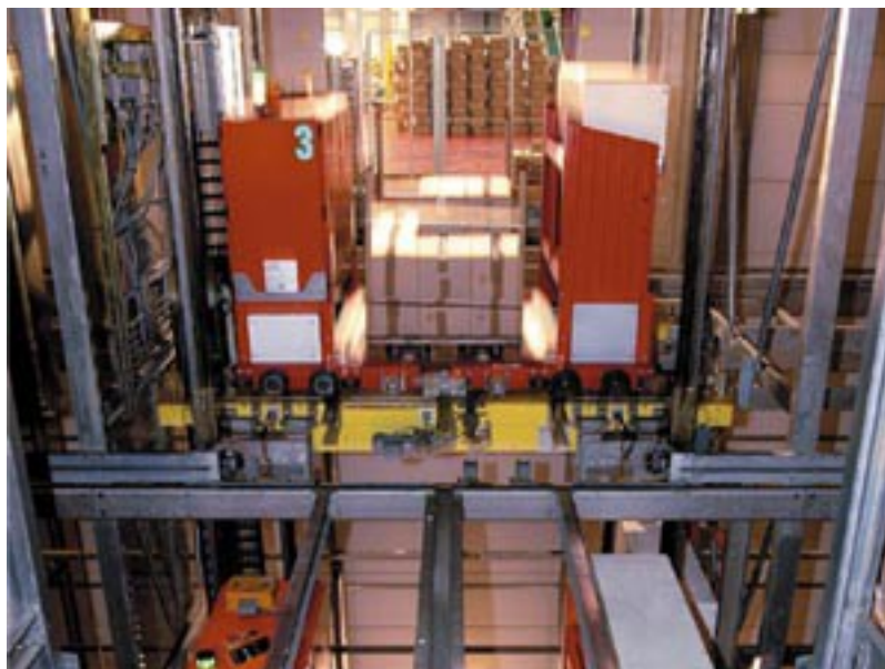
Figura 3.7: Veicolo Magmatic sull'elevatore
