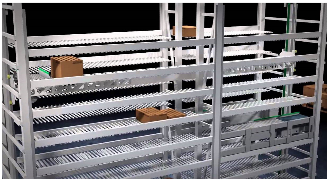
Figura 3.15: Tecnologia di sollevamento a trave del VLS
