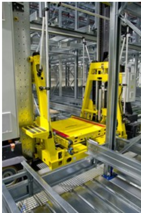
Figura 3.5: Sistema Lift&Run di SSI Schafer
