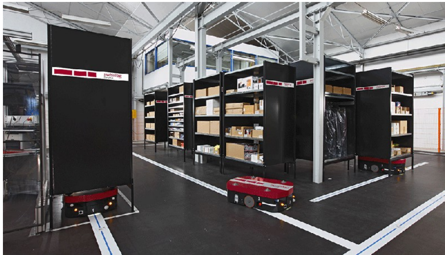
Figura 3.21: Sistema Carry Pick di Swisslog
