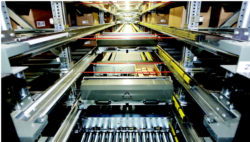
Figura 3.9: OSR System di Knapp
