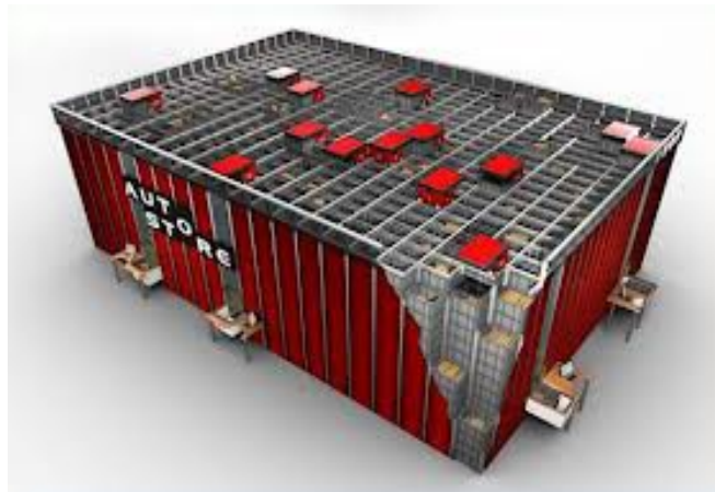
Figura 3.19: Configurazione impianto di Swisslog - Autostore
