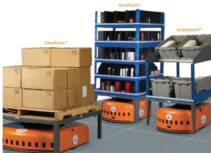
Figura 3.20: Robot del sistema Kiva
