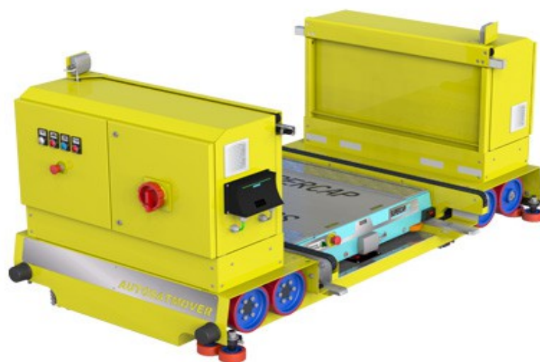
Figura 3.3: Autosatmover con shuttle Supercap
