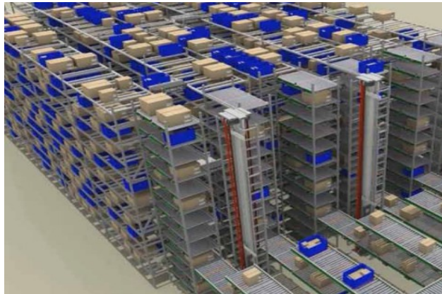
Figura 3.12: Configurazione impianto con Dematic Multishuttle 2
