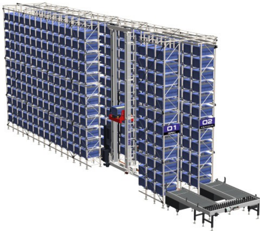
Figura 2.7: Layout del singolo corridoio di un end-of-aisle OPS con AS-RS e horse-shoe configuration
