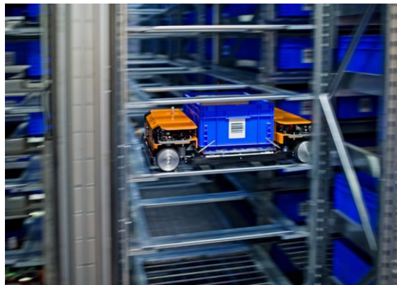
Figura 3.17: Shuttle AiV di YLog
