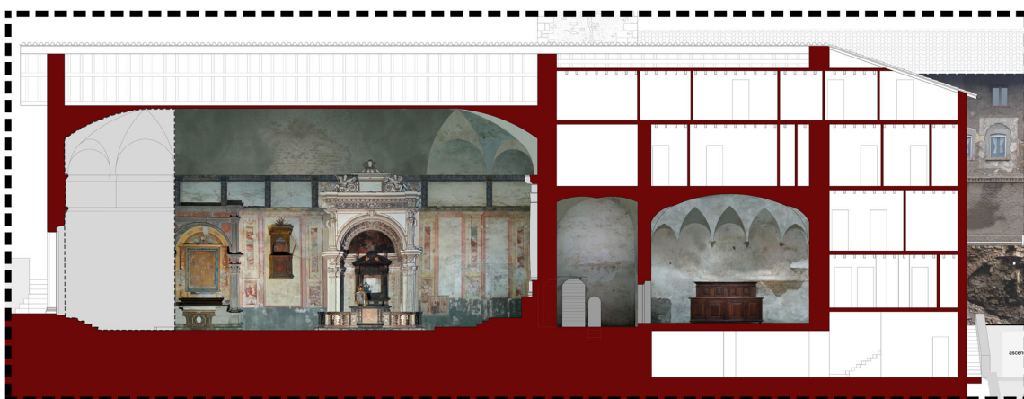
Figura 7 Sezione longitudinale della chiesa, dove si notano (da sinistra a destra): l'ingresso dei fedeli all'aula, lo spazio di collegamento con il chiostro e la sagrestia
