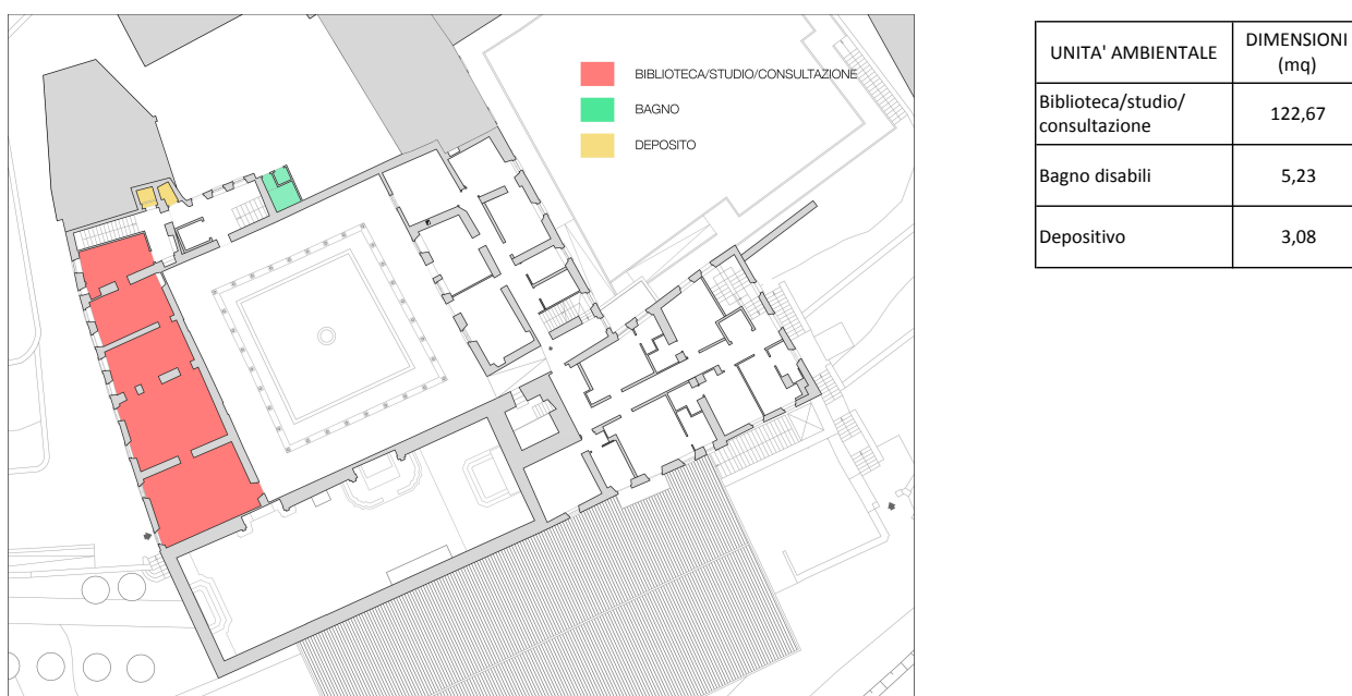
Figura 37_Distribuzione planimetrica delle attività di biblioteca/aule studio e tabella dei dati dimensionali
