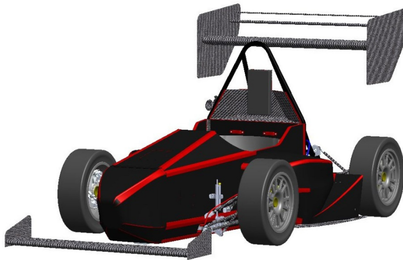
Figura 4.57 Configurazione “low drag” modello 3.7.
