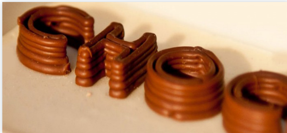
Fig.24 Cioccolato stampato con tecnologia FDM.
