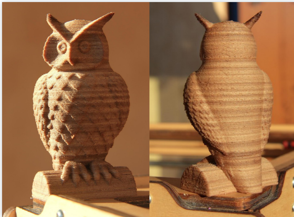
Fig.22 Esempio di oggetto stampato in Laywood.
