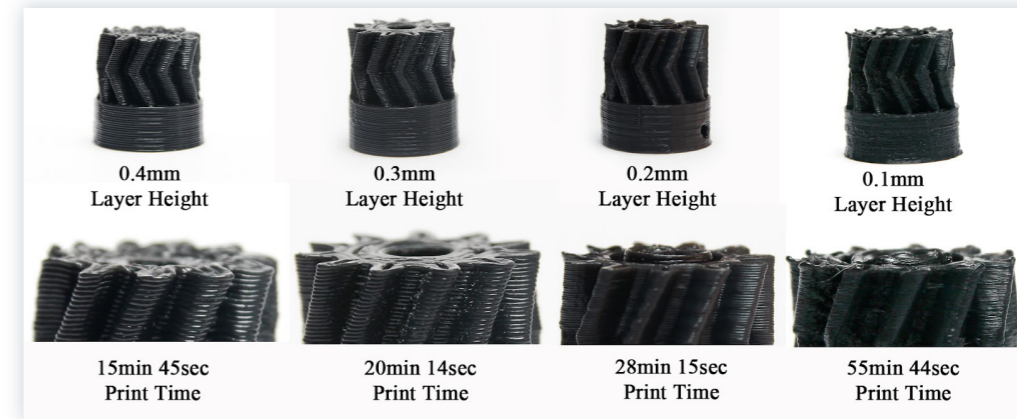
Fig.29 Oggetto stampato con diverse altezze layer. L'altezza layer è un parametro molto importante che influisce sia sulla resa qualitativa dell'oggetto stampato sia sul tempo di stampa.
