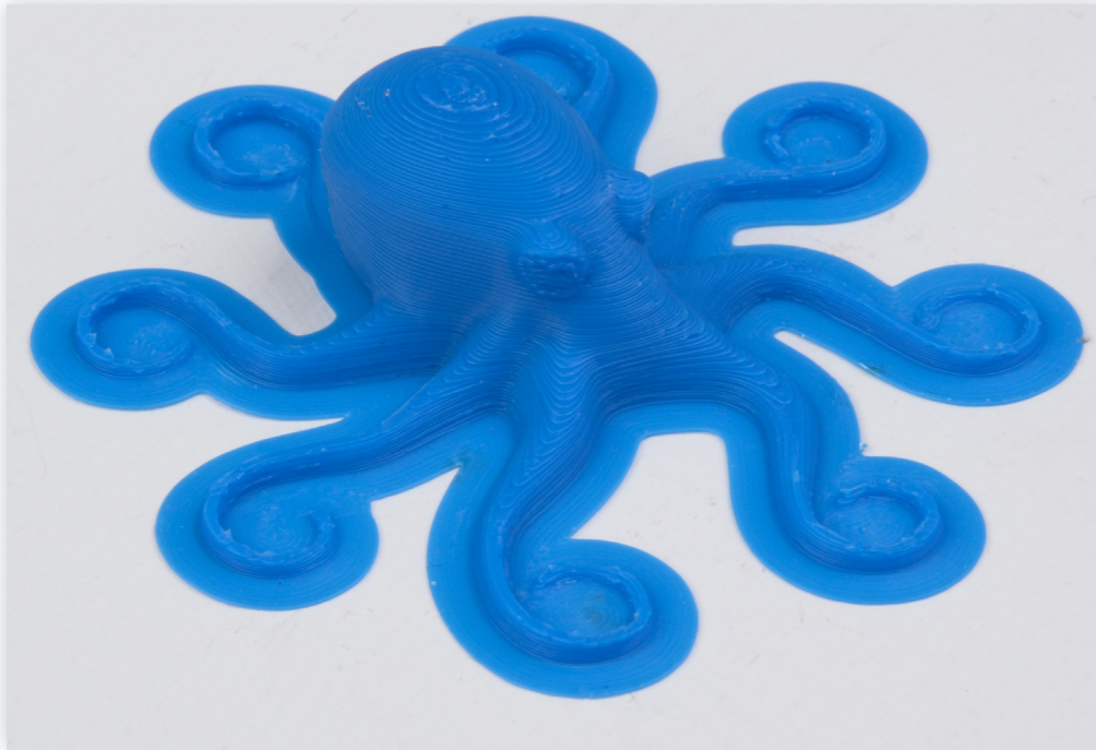
Fig.37 Esempio di oggetto stampato con il brim.
