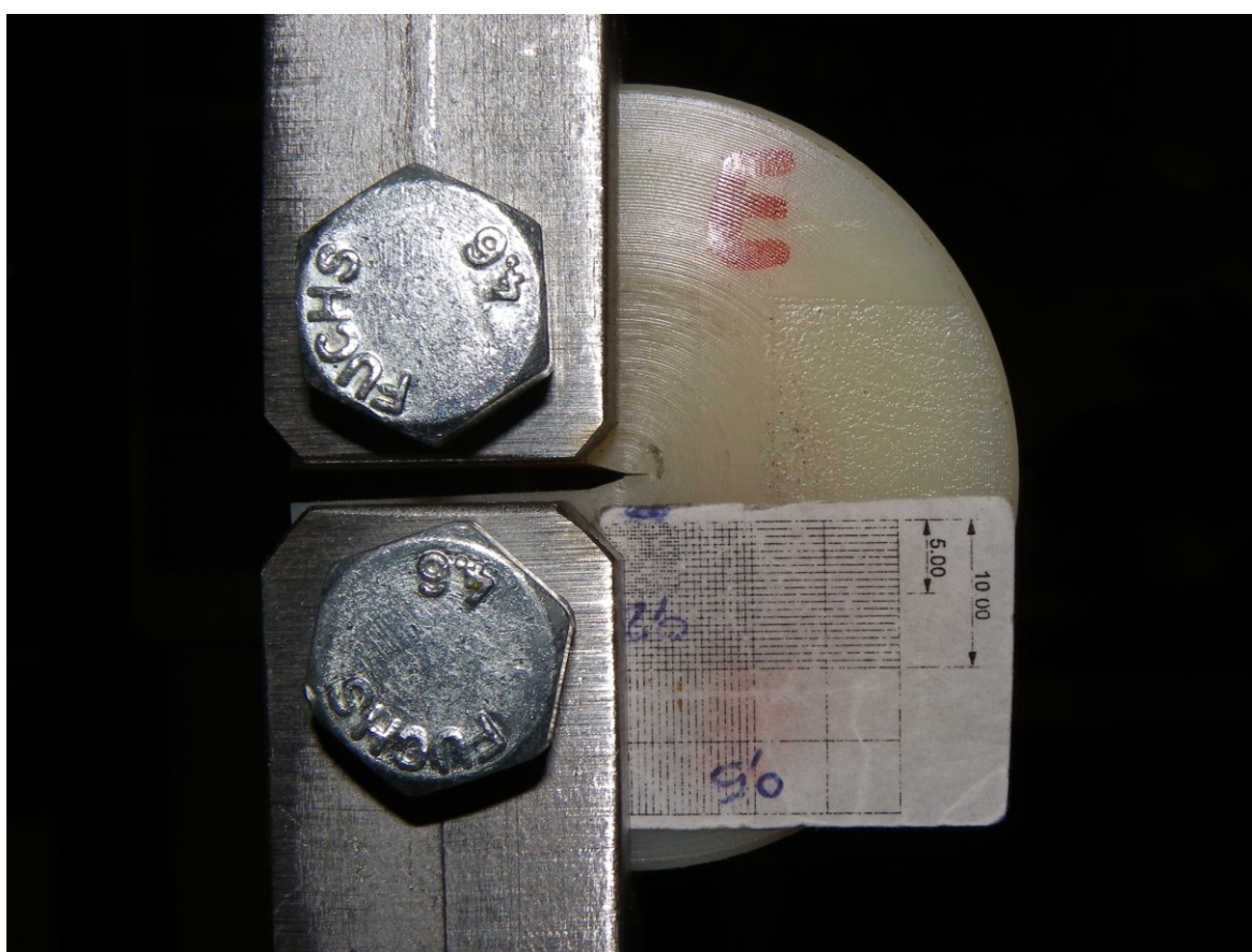
Fig. 34: Fotografia del provino con la griglia per la misurazione della cricca
