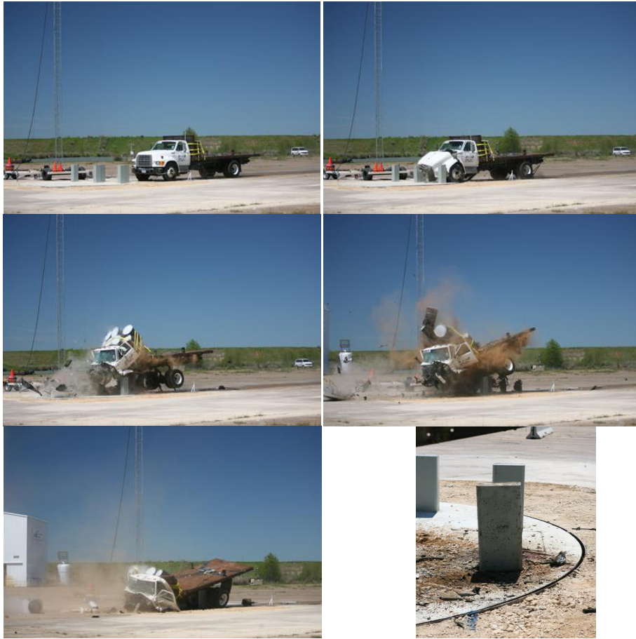
Figura 91. Sequenza di un crash test eseguito su una piattaforma girevole, (23) per verificare la rispondenza alla categoria K12: veicolo da 5 ton che viaggia a 80 km/h.
