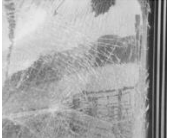
Figura 56. Rottura vetro stratificato. (18)
