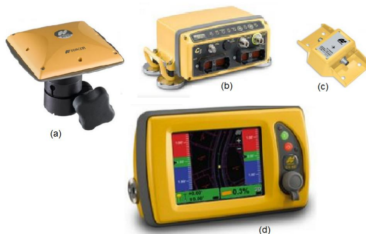
Figura 5.1 Componenti del sistema di machine control X63 Topcon: (a) antenna GPS Topcon MC-A1; (b) ricevitore GPS Topcon RC-M3; (c) sensore di inclinazione TS-1; (d) control box GX-60
