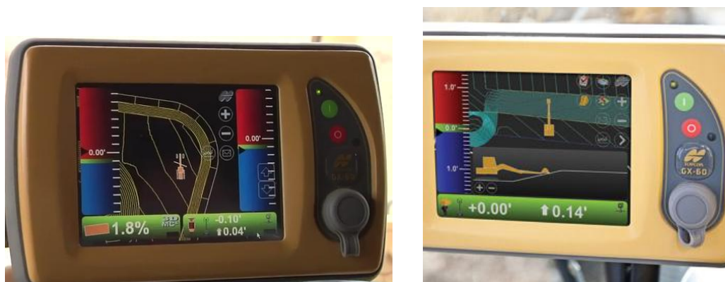
Figura 2.6 Esempi di interfaccia grafica di un sistema di machine control: sullo schermo sono presenti light bars , le indicazioni sulla posizione del braccio di scavo, la posizione del mezzo e i pulsanti per accedere alle funzionalità del sistema
