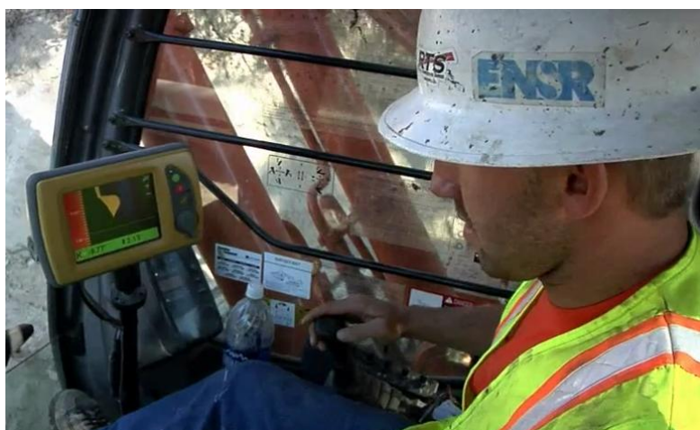
Figura 2.5 Operatore alla guida di un escavatore con l'assistenza di un sistema di navigazione
