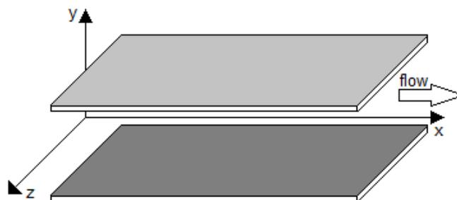
Figure 2.1: Canale piano e sistema di riferimento.
