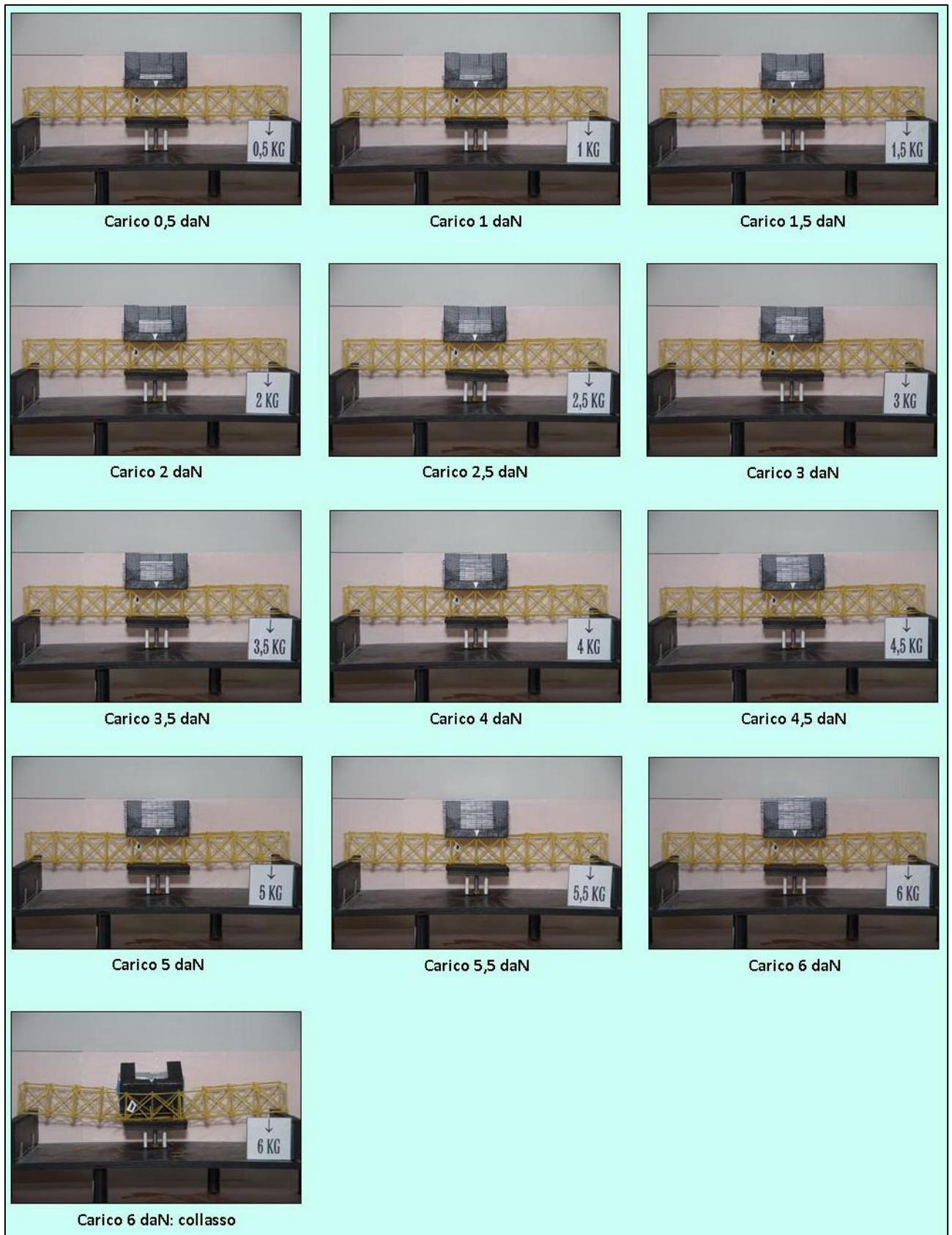
FIGURA 522 CICLO DI CARICO (FOTO FRONTALI)
