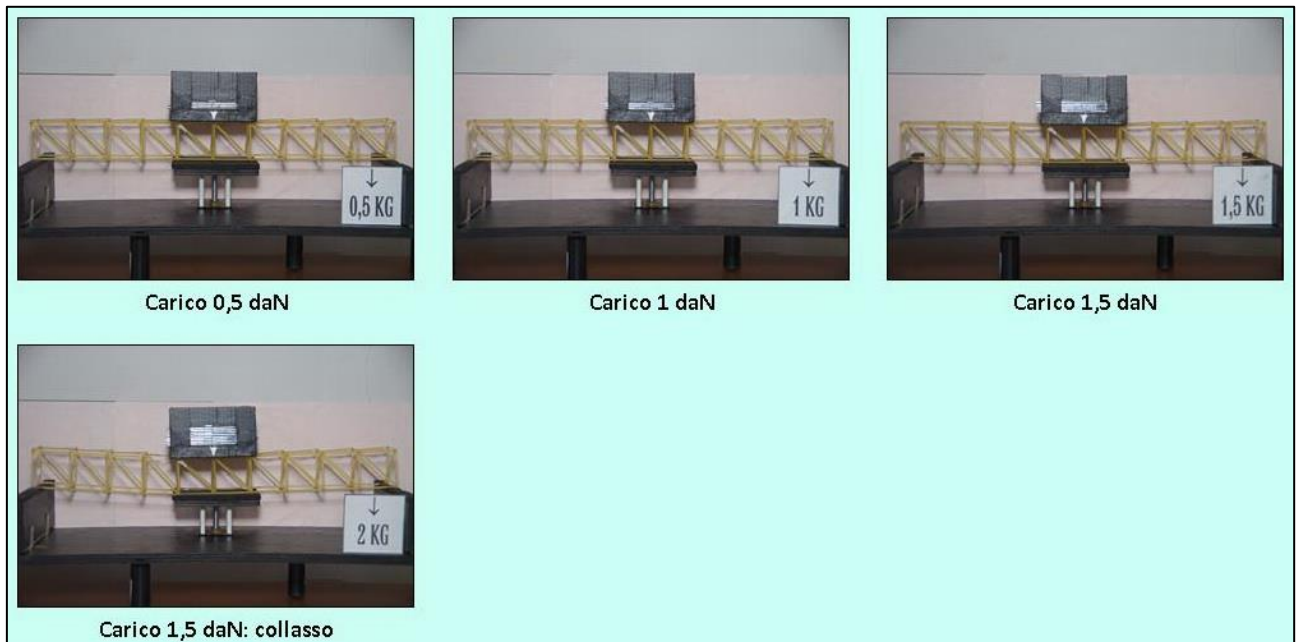
FIGURA 336 CICLO DI CARICO (FOTO FRONTALI)
