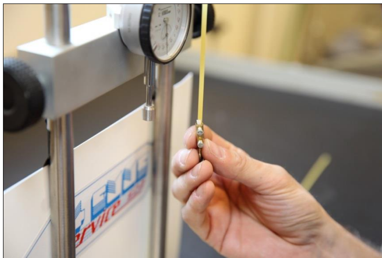
FIGURA 224 IL SISTEMA DI AGGANCIO ALLA BAVETTA DOVE SI APPENDEVANO I PESI
