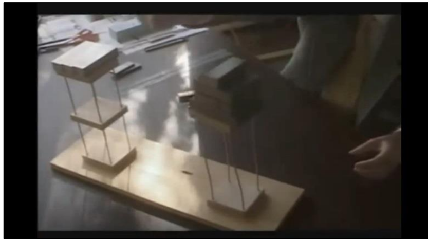
FIGURA 61 IL MODELLINO DI DESTRA INVECE SENZA IL PIANO INTERMEDIO CON POCHISSIMO CARICO COLLASSA
