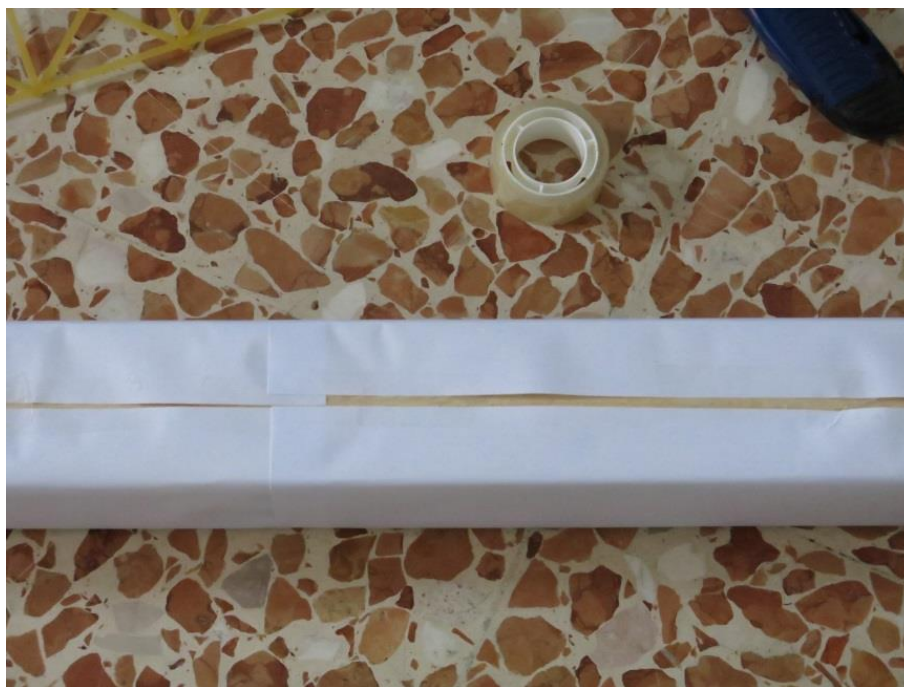
FIGURA 260 INTERPOSIZIONE DI CARTA FRA LA DIMA E LE BAVETTE PER NON FARLE INCOLLARE
