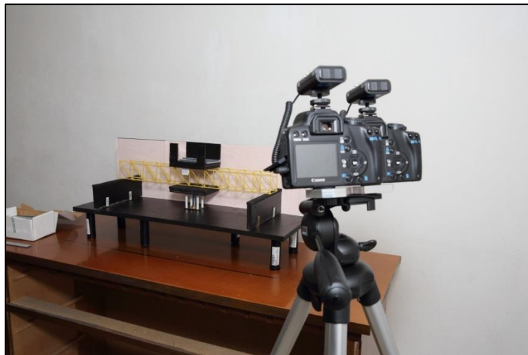
FIGURA 265 LA COPPIA DI REFLEX EOS 1000D CON IL LORO PUNTO DI PRESA
