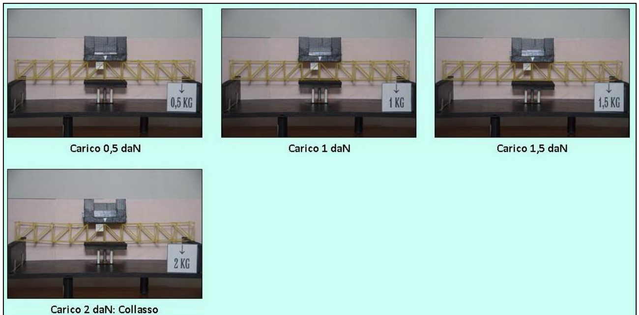
FIGURA 292 CICLO DI CARICO (FOTO FRONTALI)
