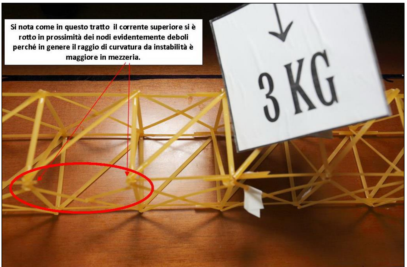
FIGURA 405 LE DEFORMAZIONI PIÙ IMPORTANTI CHE SI OSSERVANO NEL MODELLINO SOTTO CARICO
