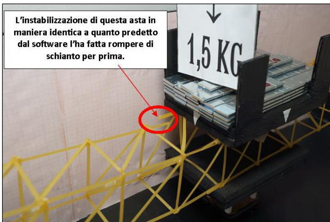
FIGURA 346 INSTABILITÀ NEL MODELLO FISICO
