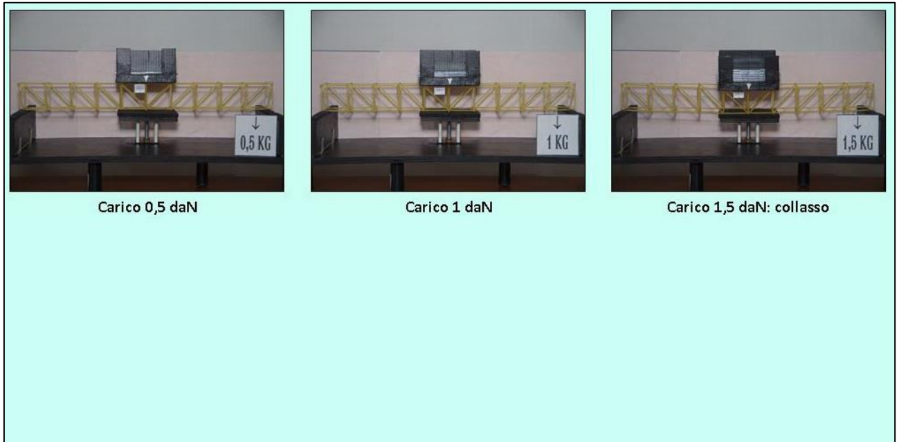
FIGURA 303 CICLO DI CARICO (FOTO FRONTALI)
