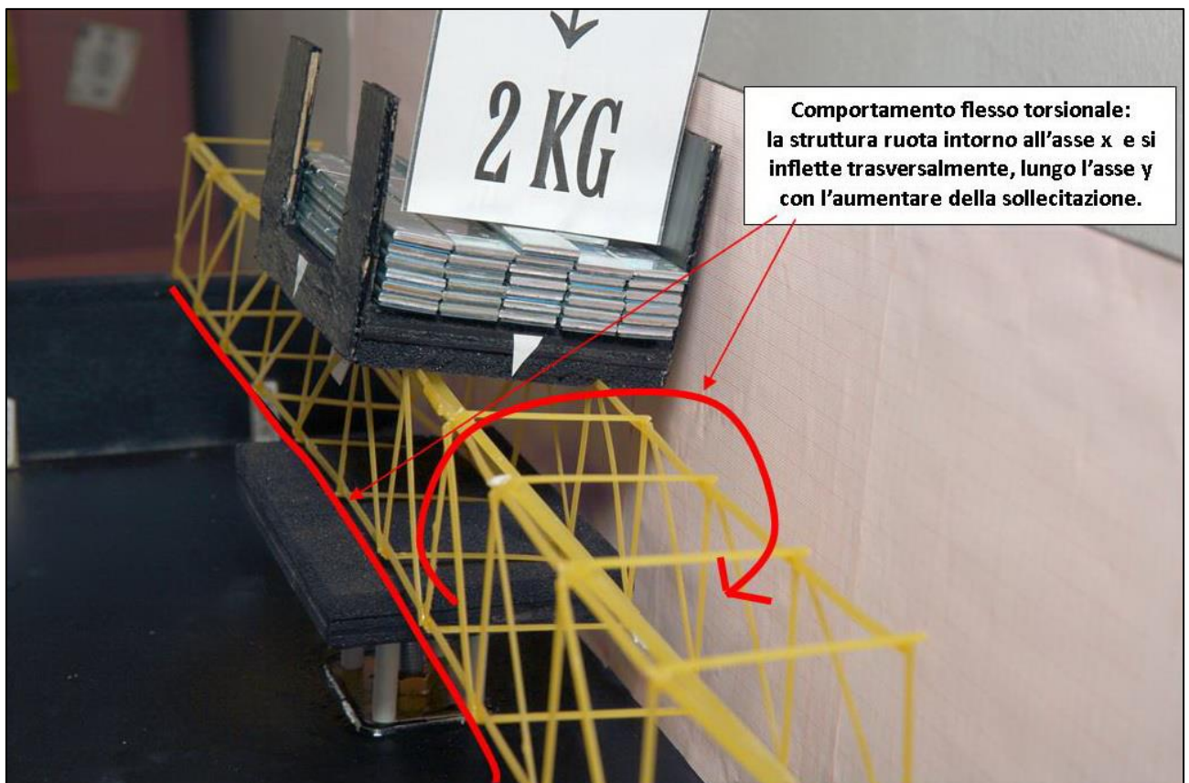
FIGURA 293 LE DEFORMAZIONI PIÙ IMPORTANTI CHE SI OSSERVANO NEL MODELLINO SOTTO CARICO
