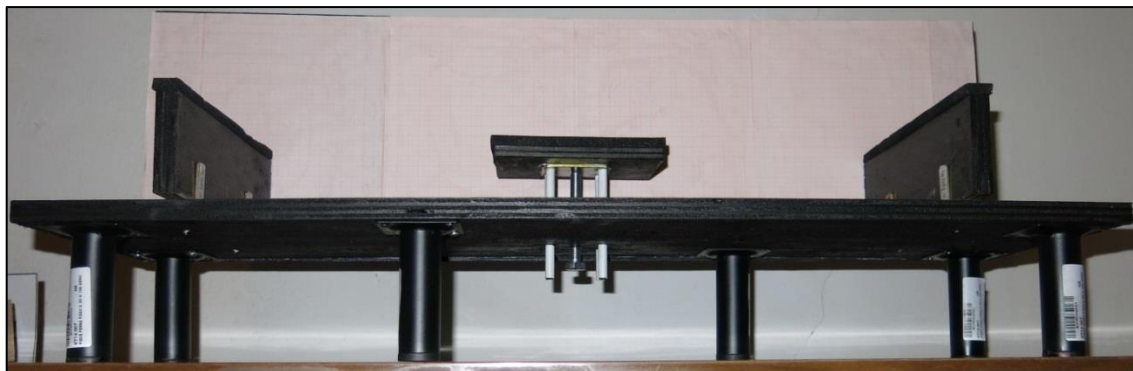
FIGURA 251 IL SUPPORTO PER LE PROVE DI CARICO DEI MODELLINI
