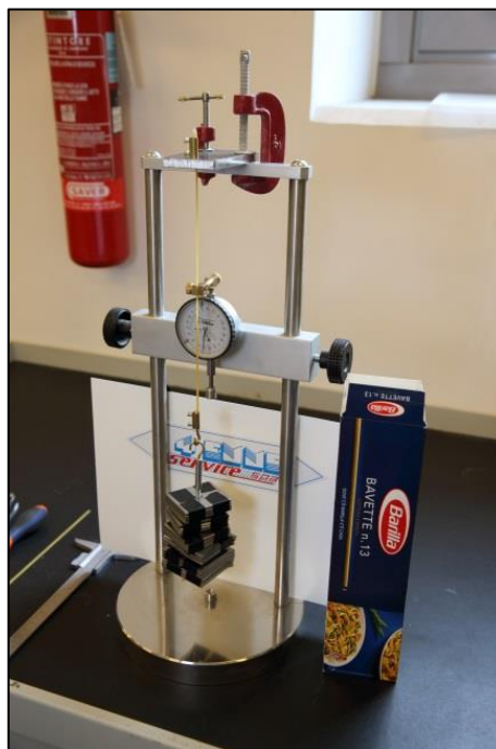
FIGURA 233 OLTRE 1 DAN APPESO AD UNA BAVETTA
