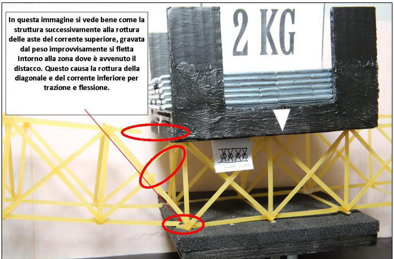
FIGURA 326 LE DEFORMAZIONI PIÙ IMPORTANTI CHE SI OSSERVANO NEL MODELLINO SOTTO CARICO
