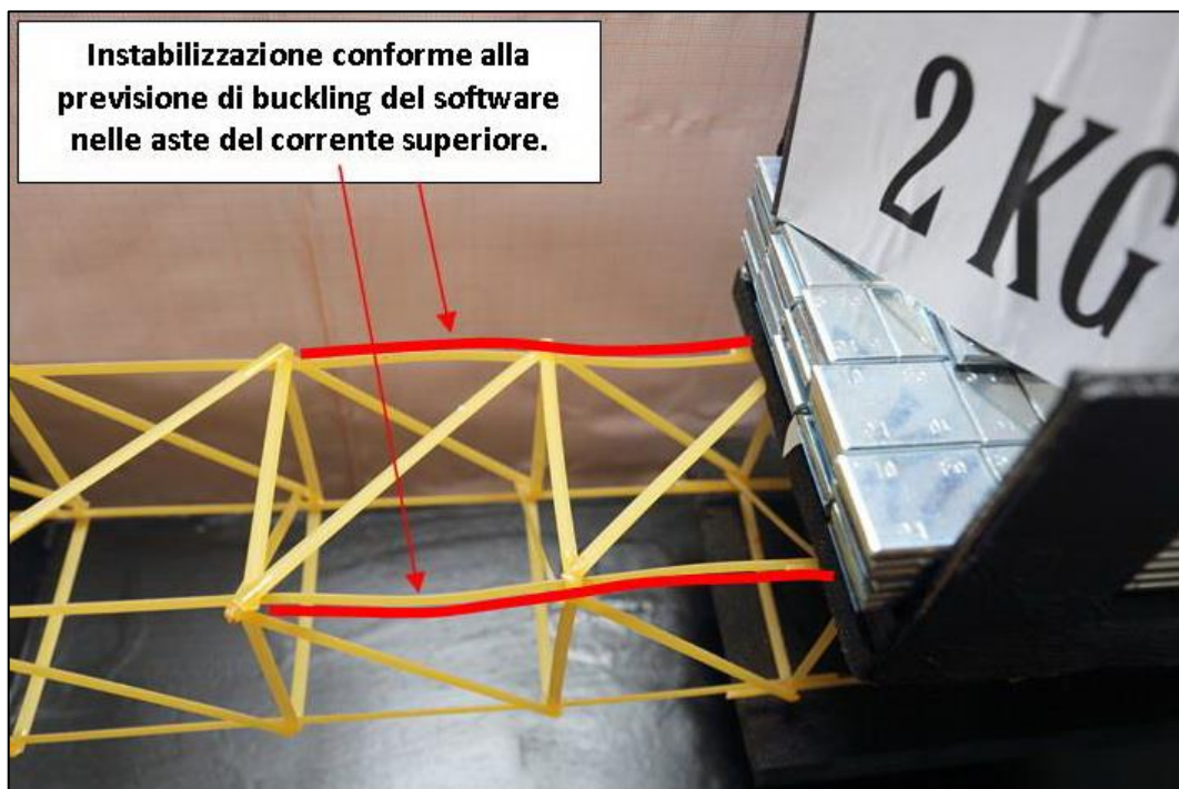
FIGURA 357 INSTABILITÀ NEL MODELLO FISICO
