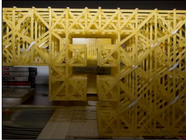
FIGURA 219 DETTAGLIO DELLA TRAVE "BULL DIAMOND" NELLA FESSURA "A CALCO" PER ENTRARE TRASLANDO NEL SUPPORTO
