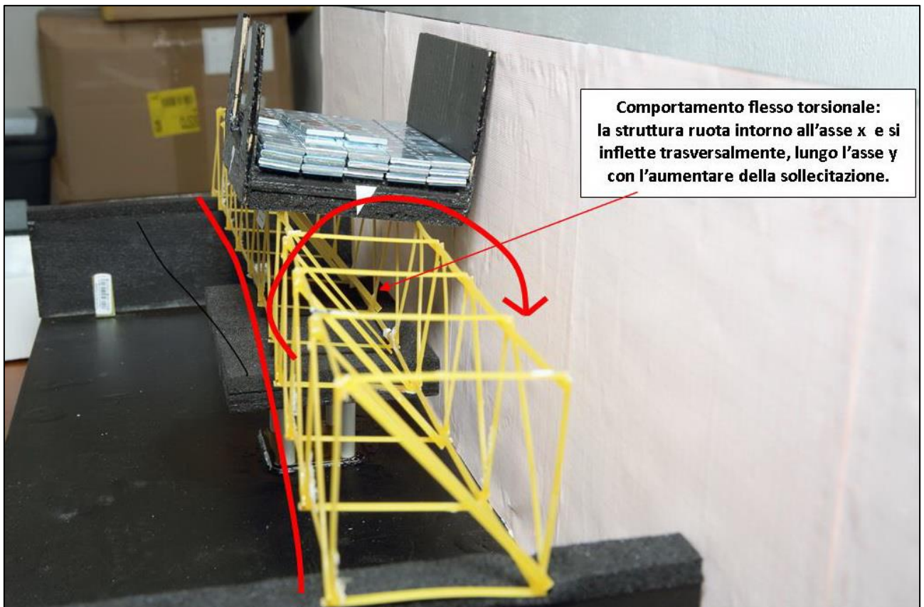
FIGURA 282 LE DEFORMAZIONI PIÙ IMPORTANTI CHE SI OSSERVANO NEL MODELLINO SOTTO CARICO
