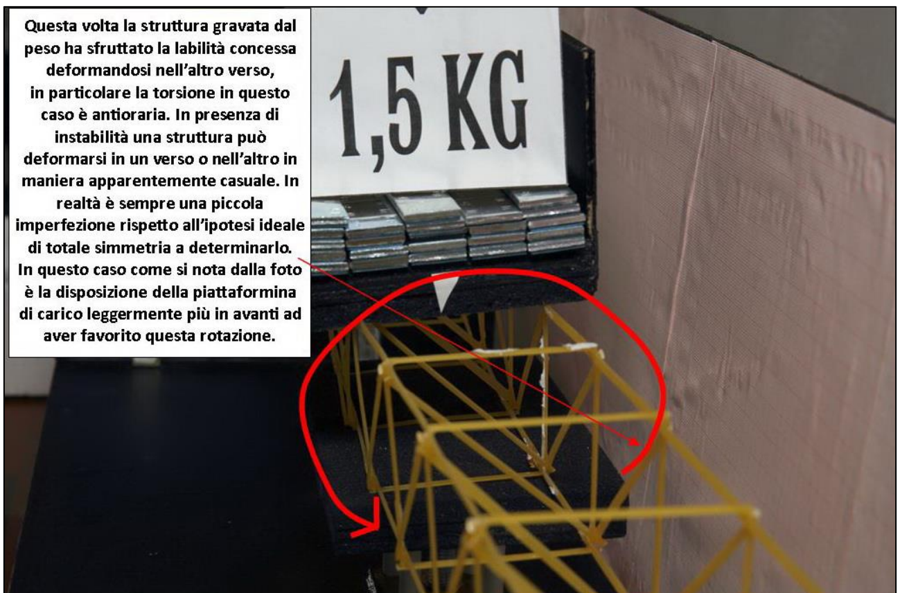
FIGURA 304 LE DEFORMAZIONI PIÙ IMPORTANTI CHE SI OSSERVANO NEL MODELLINO SOTTO CARICO
