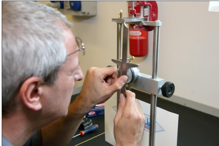
FIGURA 226 MISURAZIONE ACCURATISSIMA CON UN CALIBRO DI PRECISIONE DELLA DISTANZA l_0
