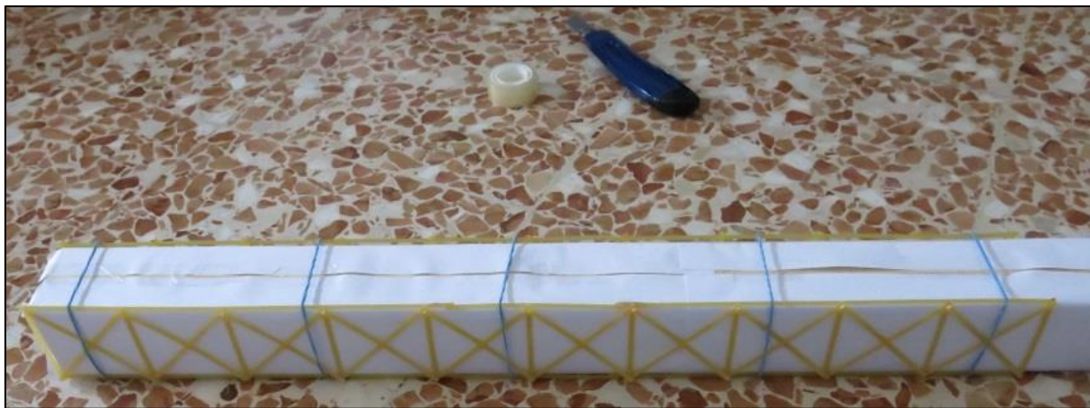
FIGURA 259 DISPOSIZIONE DEI 2 LATI SULLA DIMA IN LEGNO TRATTENUTI DA ELASTICI
