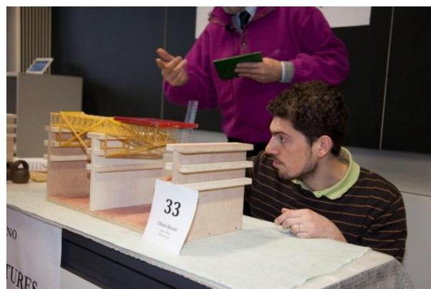
FIGURA 206 L'ING. BASSOLI, COLLABORATORE DEL PROFESSORE, CHE MISURA CON CURA LA FRECCIA DI ABBASSAMENTO
