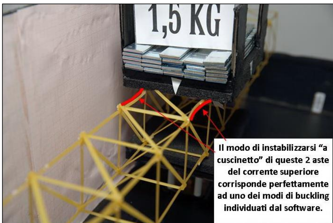
FIGURA 335 INSTABILITÀ NEL MODELLO FISICO
