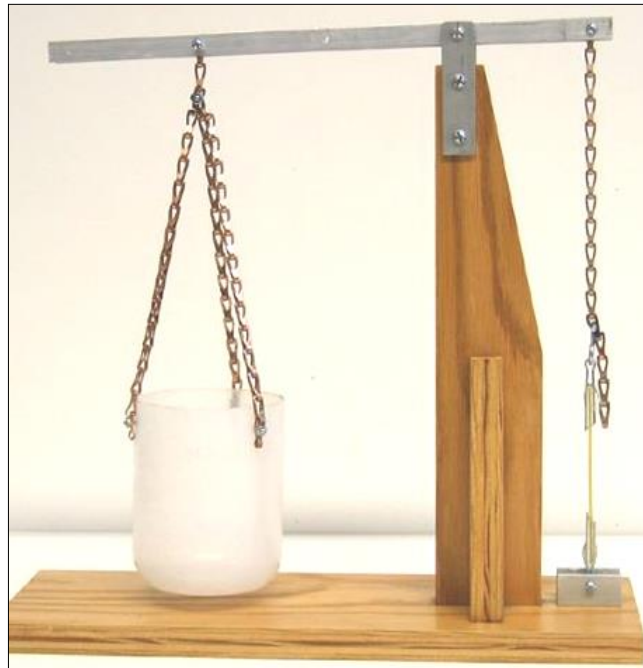
FIGURA 170 SEMPLICE APPARATO PER PROVA A TRAZIONE
