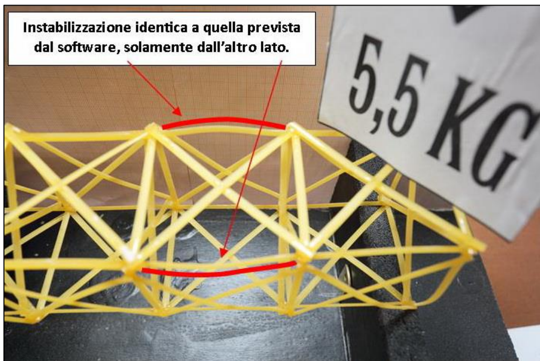
FIGURA 511 INSTABILITÀ NEL MODELLO FISICO
