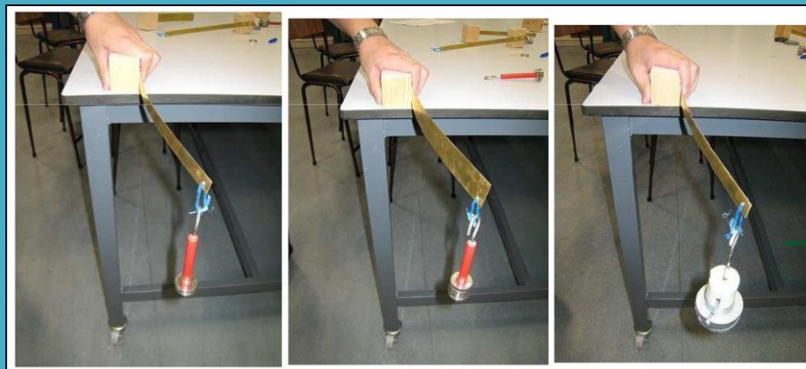
FIGURA 53 INSTABILITÀ FLESSO-TORSIONALE DI UNA BANDA METALLICA POSTA DI COLTELLO
