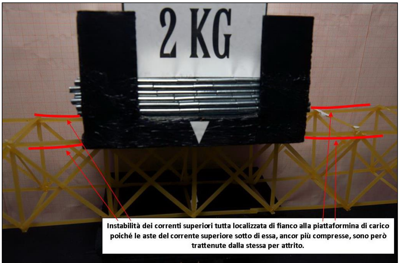
FIGURA 316 LE DEFORMAZIONI PIÙ IMPORTANTI CHE SI OSSERVANO NEL MODELLINO SOTTO CARICO
