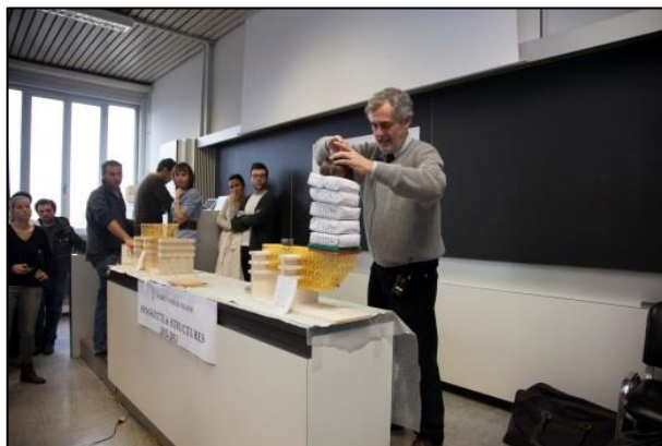
FIGURA 221 LA TRAVE "BULL DIAMOND" VIENE PROVATA E CARICATA DAL PROFESSORE CON DIVERSI KG E ANCORA NON CEDE
