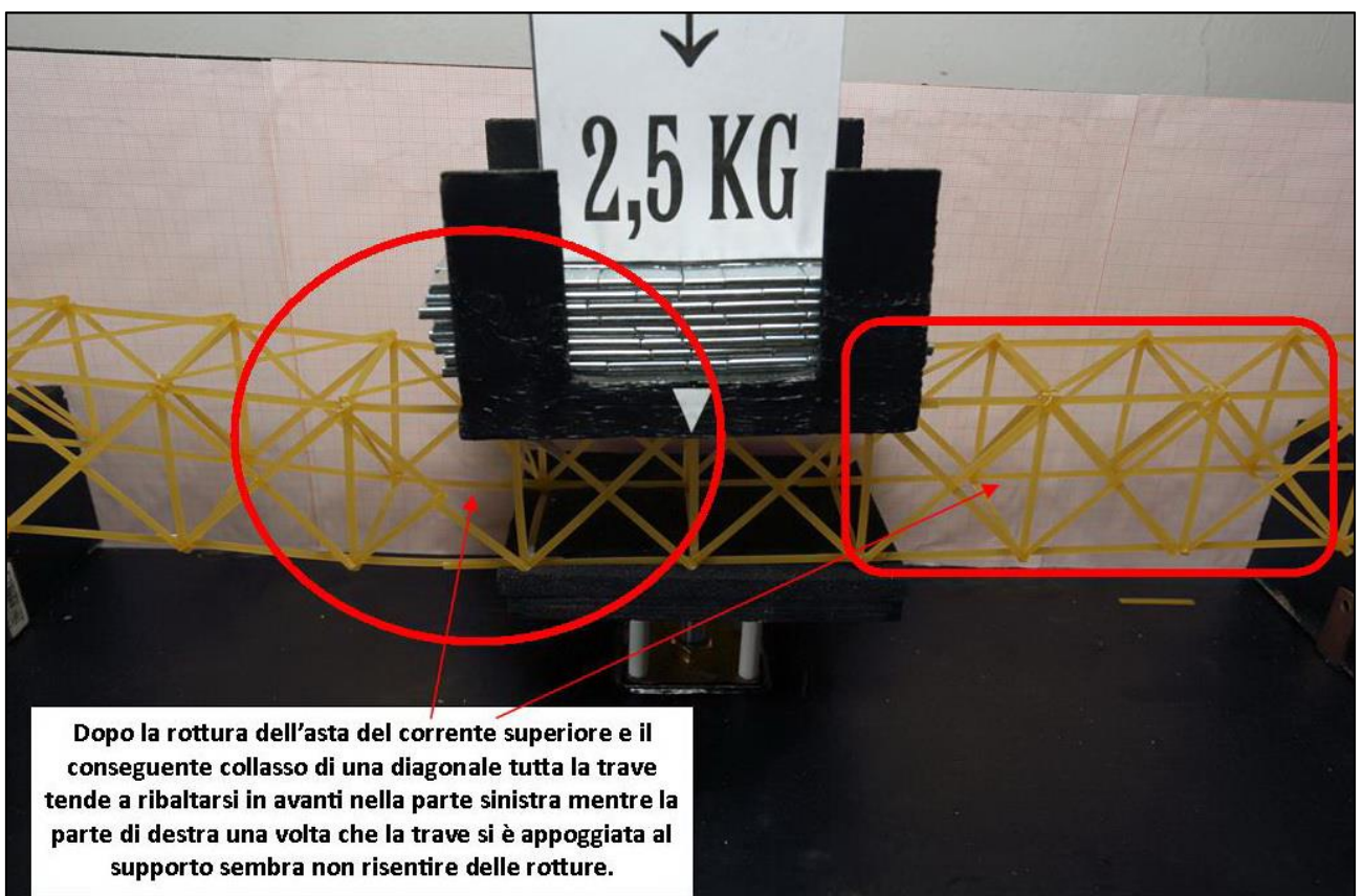
FIGURA 383 LE DEFORMAZIONI PIÙ IMPORTANTI CHE SI OSSERVANO NEL MODELLINO SOTTO CARICO
