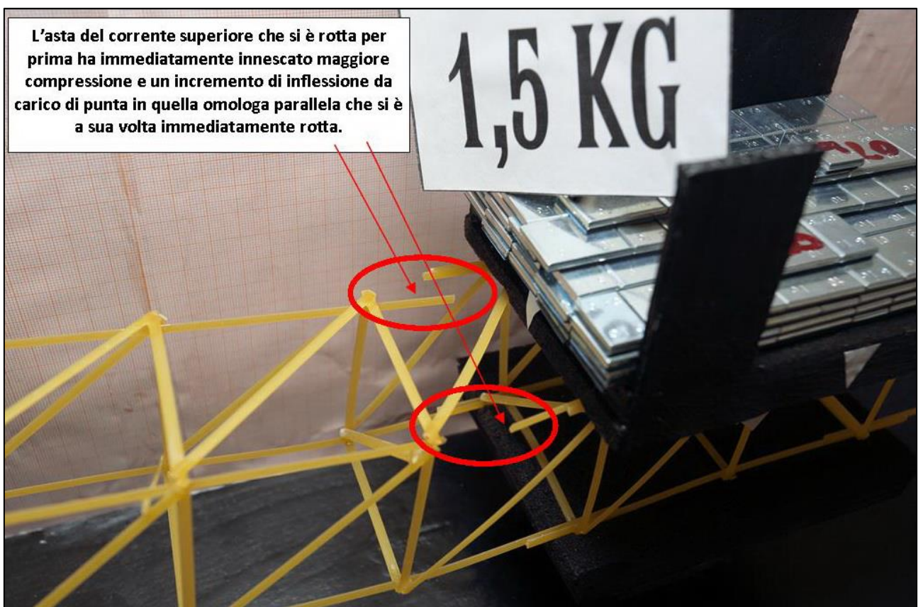
FIGURA 350 LE DEFORMAZIONI PIÙ IMPORTANTI CHE SI OSSERVANO NEL MODELLINO SOTTO CARICO
