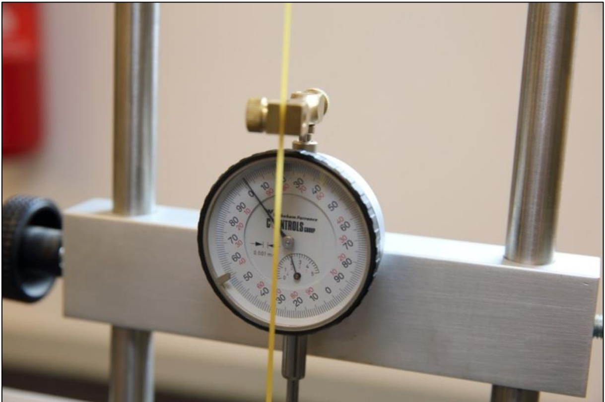
FIGURA 222 IL FLESSIMETRO IMPIEGATO AVEVA UNA PRECISIONE DEL MILLESIMO DI MILLIMETRO
