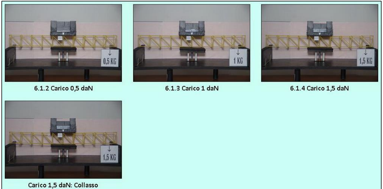
FIGURA 281 CICLO DI CARICO (FOTO FRONTALI)
