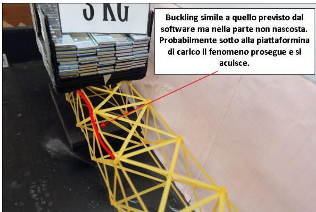
FIGURA 412 INSTABILITÀ NEL MODELLO FISICO
