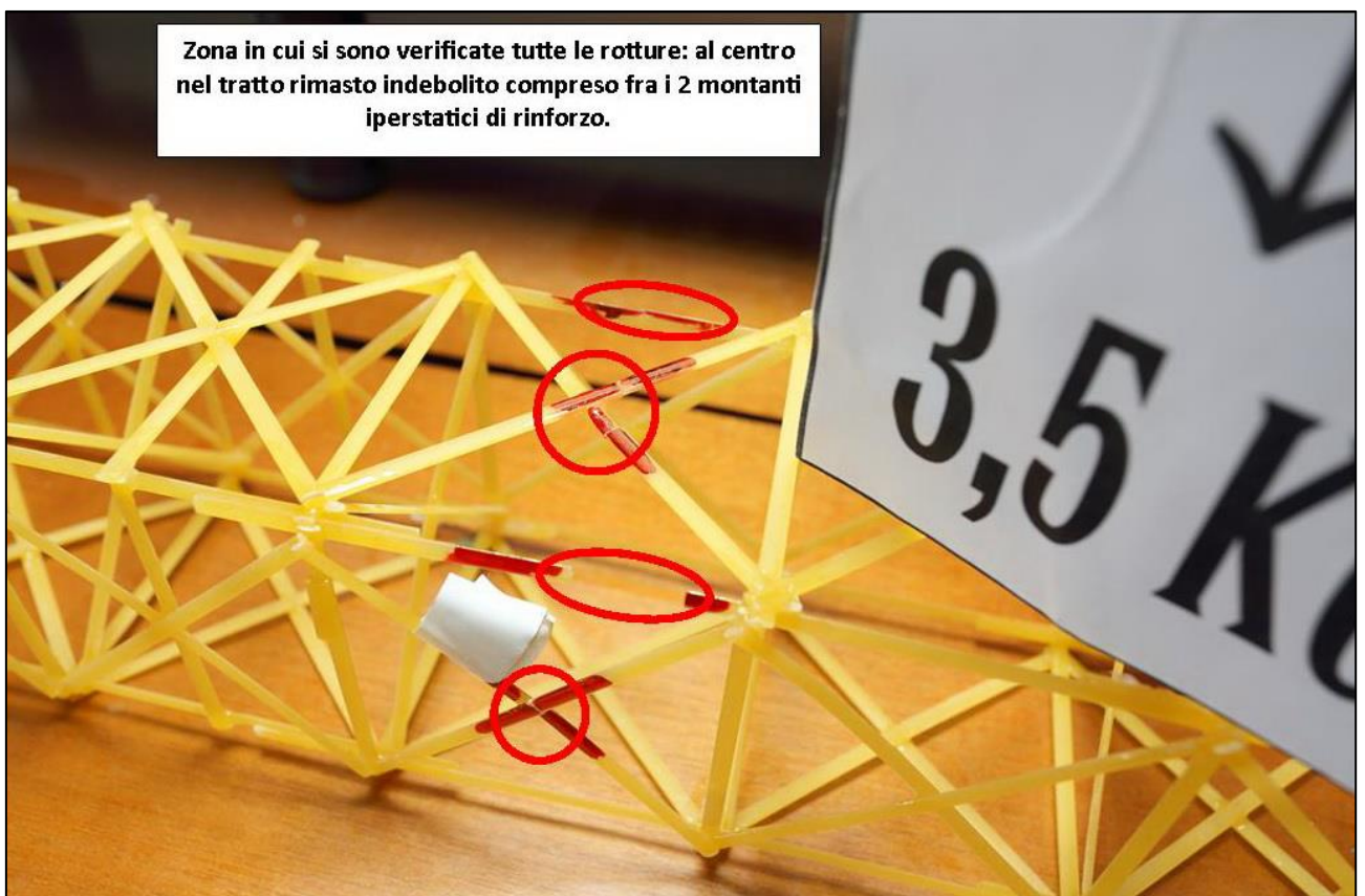
FIGURA 471 LE DEFORMAZIONI PIÙ IMPORTANTI CHE SI OSSERVANO NEL MODELLINO SOTTO CARICO
