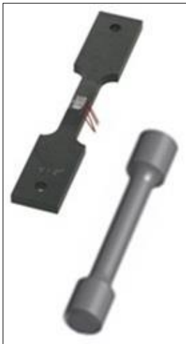
FIGURA 166 TIPICI PROVINI CAMPIONE
