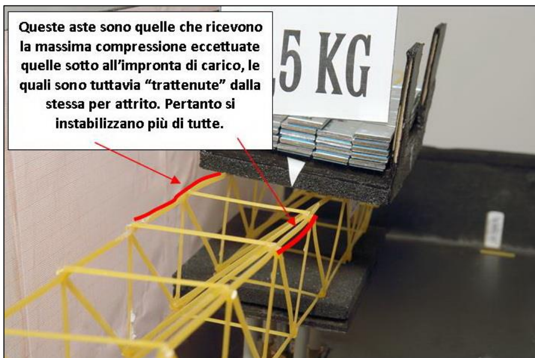
FIGURA 302 INSTABILITÀ NEL MODELLO FISICO
