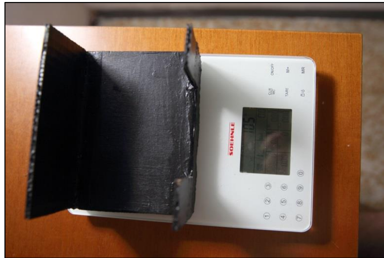
FIGURA 255 PESATURA DELLA PIATTAFORMINA DI CARICO STESSA: IL PESO ANDAVA CONTEGGIATO NEI 500 G
