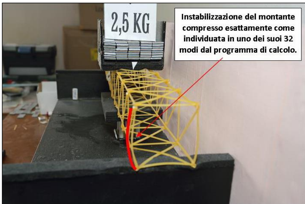
FIGURA 500 INSTABILITÀ NEL MODELLO FISICO
