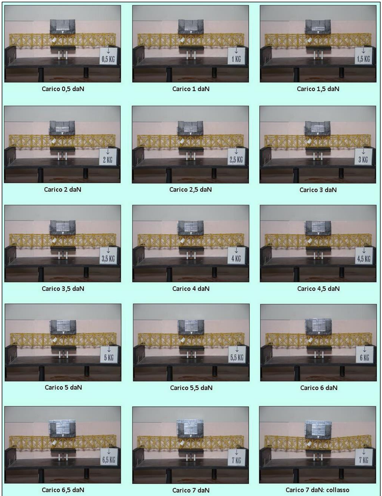
FIGURA 532 CICLO DI CARICO (FOTO FRONTALI)
