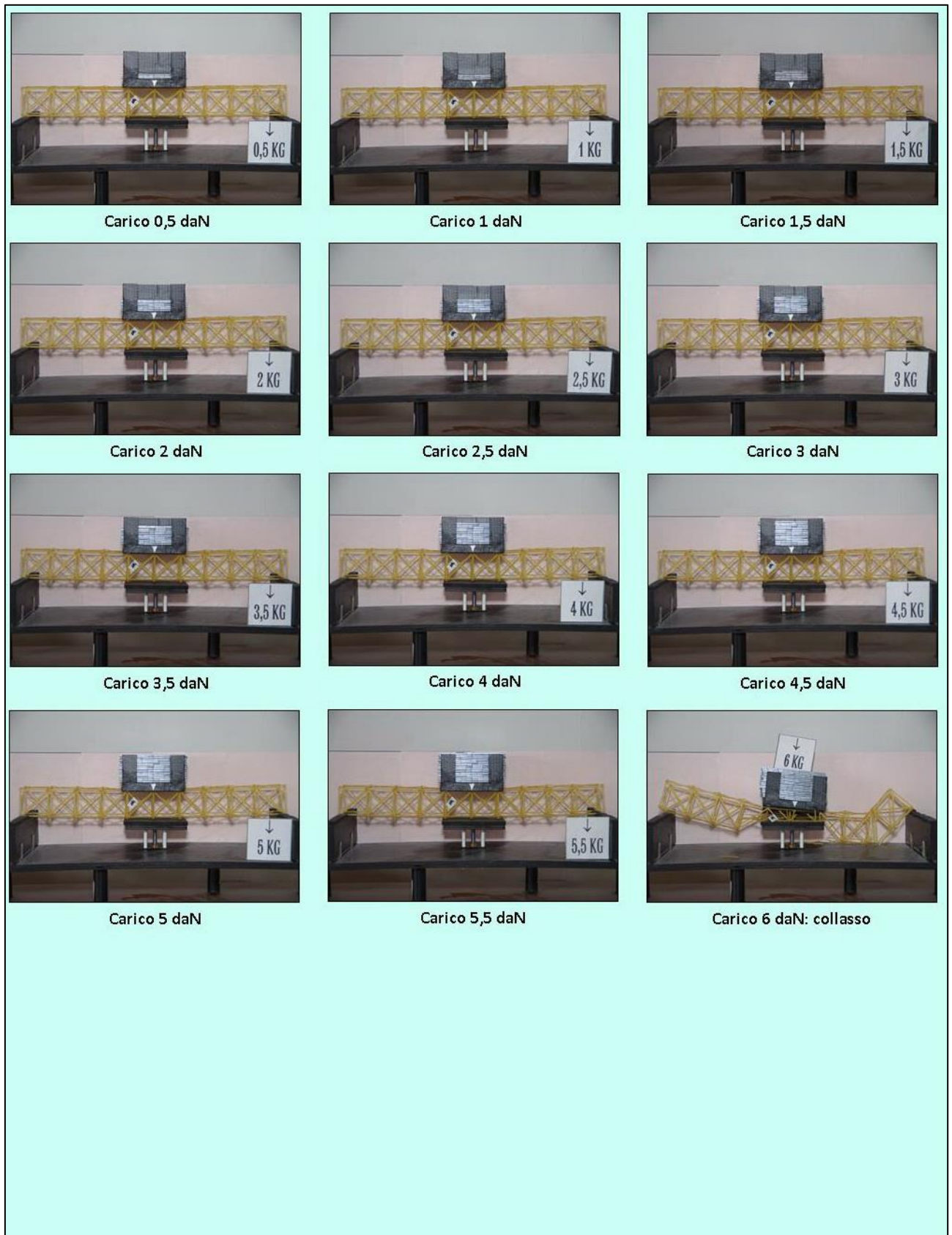
FIGURA 512 CICLO DI CARICO (FOTO FRONTALI)
