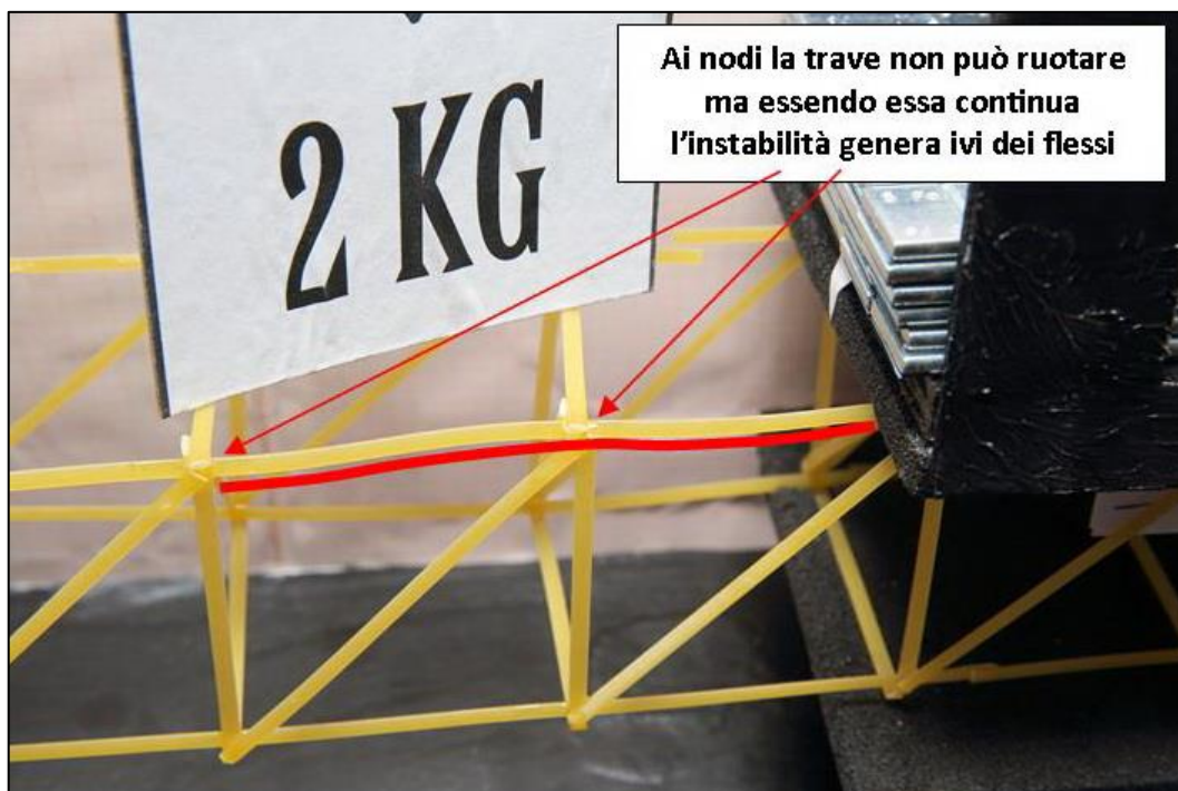
FIGURA 291 INSTABILITÀ NEL MODELLO FISICO
