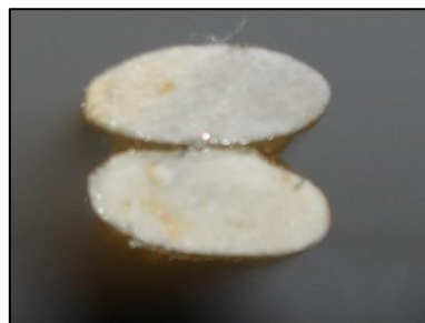
FIGURA 537 MACRO DELLA SEZIONE DI 2 BAVETTE INCOLLATE PER IL LATO CORTO
