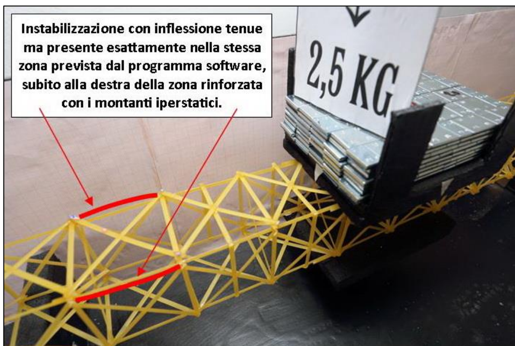
FIGURA 467 INSTABILITÀ NEL MODELLO FISICO
