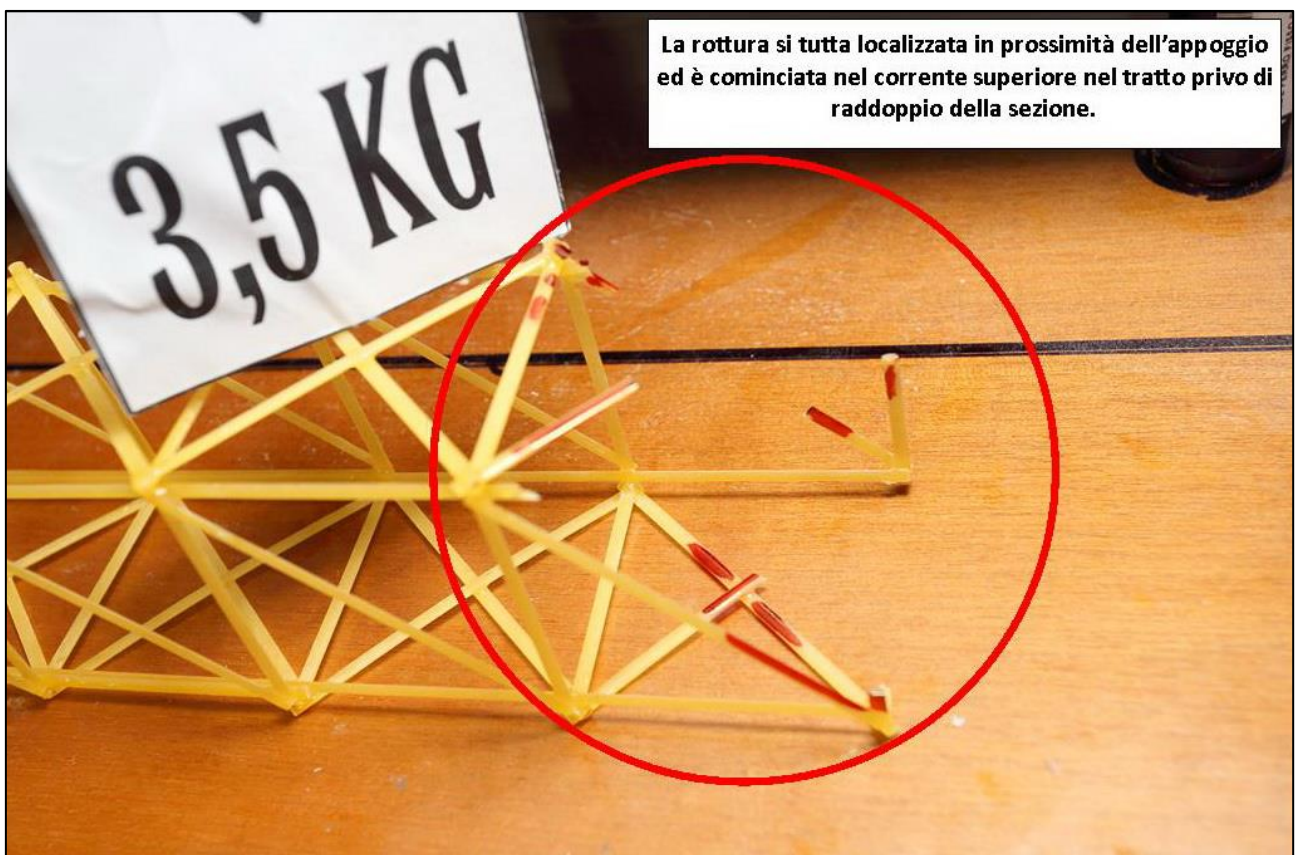
FIGURA 504 LE DEFORMAZIONI PIÙ IMPORTANTI CHE SI OSSERVANO NEL MODELLINO SOTTO CARICO
