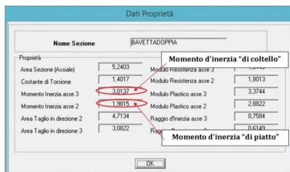
FIGURA 540 PROPRIETÀ DELLA SEZIONE "BAVETTADOPPIA" CON I 2 DIVERSI MOMENTI D'INERZIA COMPUTATI DAL SOFTWARE
