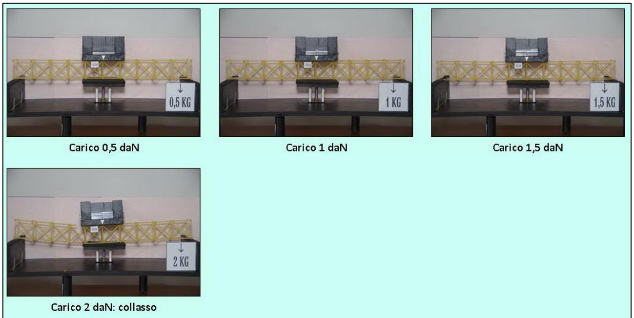
FIGURA 325 CICLO DI CARICO (FOTO FRONTALI)
