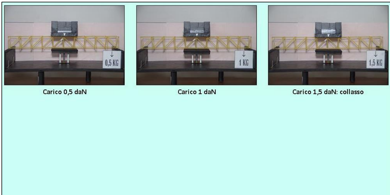
FIGURA 347 CICLO DI CARICO (FOTO FRONTALI)
