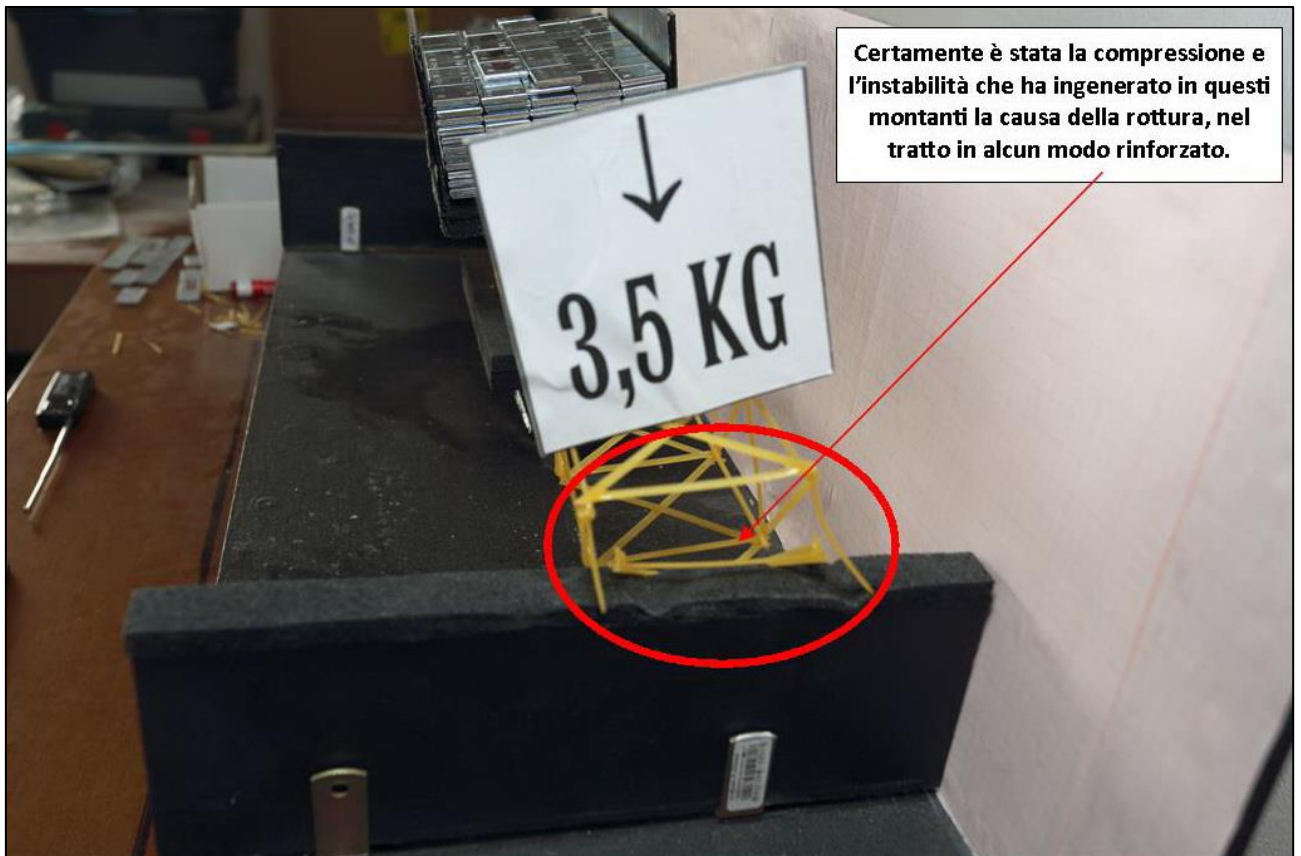
FIGURA 503 LE DEFORMAZIONI PIÙ IMPORTANTI CHE SI OSSERVANO NEL MODELLINO SOTTO CARICO
