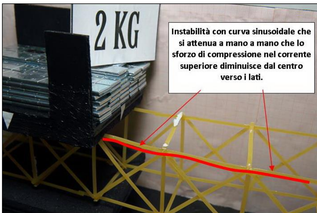
FIGURA 313 INSTABILITÀ NEL MODELLO FISICO
