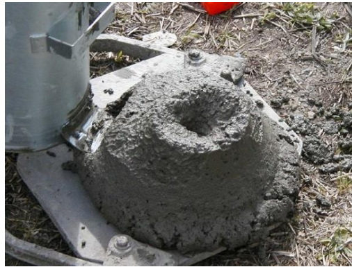
Figura 5.5 : Verifica tramite slump test del calcestruzzo
