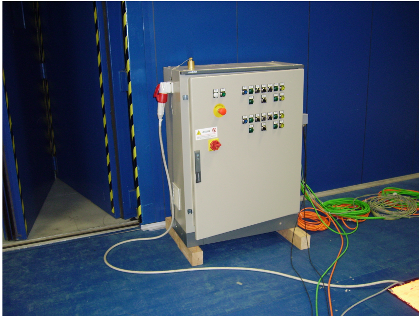
Figura 3.13: Inverter che controlla il movimento del motore
