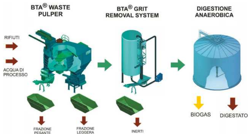
Figura 5.1 – Schema di un processo BTA di pretrattamento dell'umido 24
