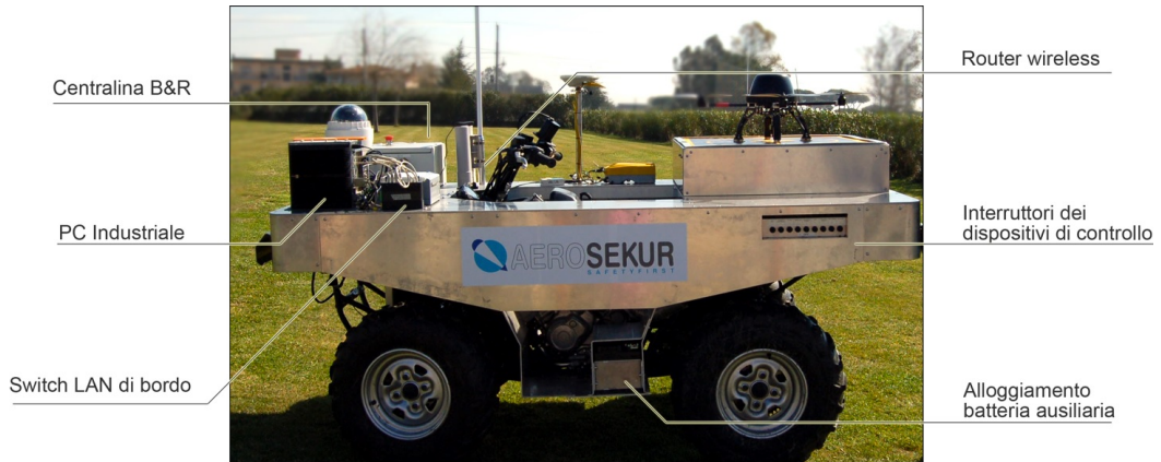
Figura 2.2: Il prototipo e la collocazione dei principali strumenti [56]
