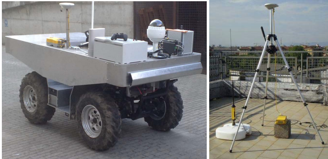
(a) GPS Trimble 5700 con antenna Zephyr sul veicolo (b) GPS Trimble MS750 con antenna Zephyr a terra
