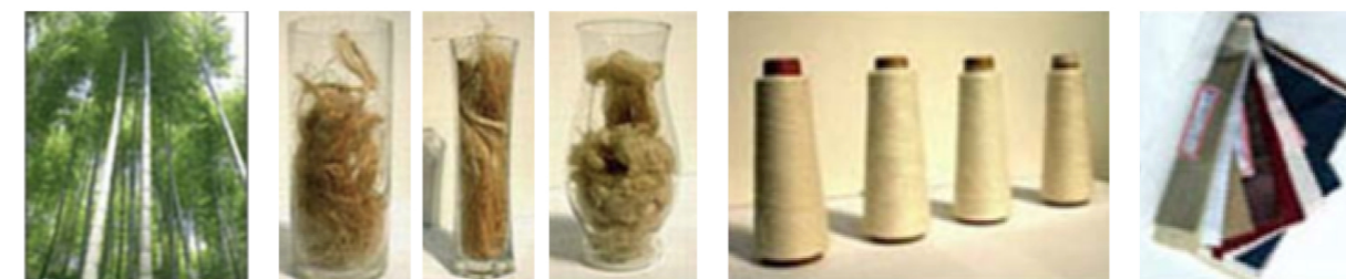
1. Bambù grezzo 2. Strati di bambù > Cottura ed evaporazione > Frammentazione e catabolismo 3. Cardatura delle fibre 4. Fibra di bambù
