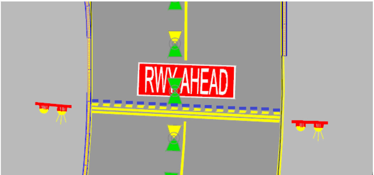
Figura 4.27: Linea tratteggiata di stop bar realizzata con vernice ad acqua gialla e microsfere Type I.
