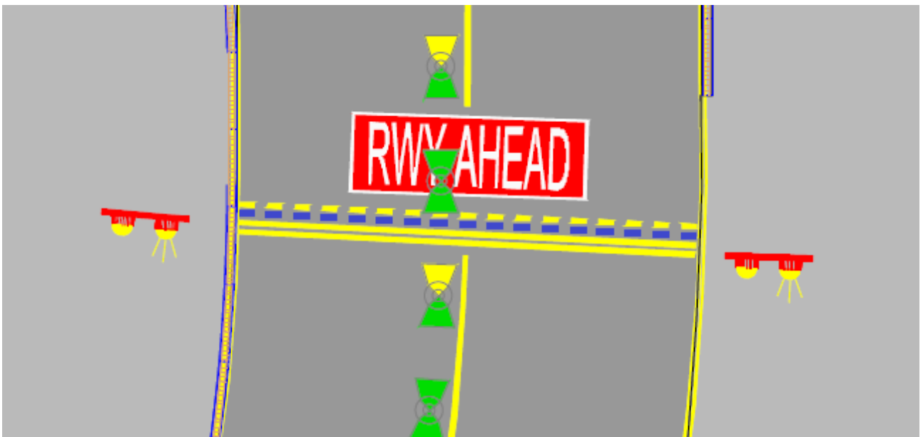
Figura 4.30: Linea tratteggiata di stop bar realizzata con vernice ad acqua gialla e microsfere Type III.
