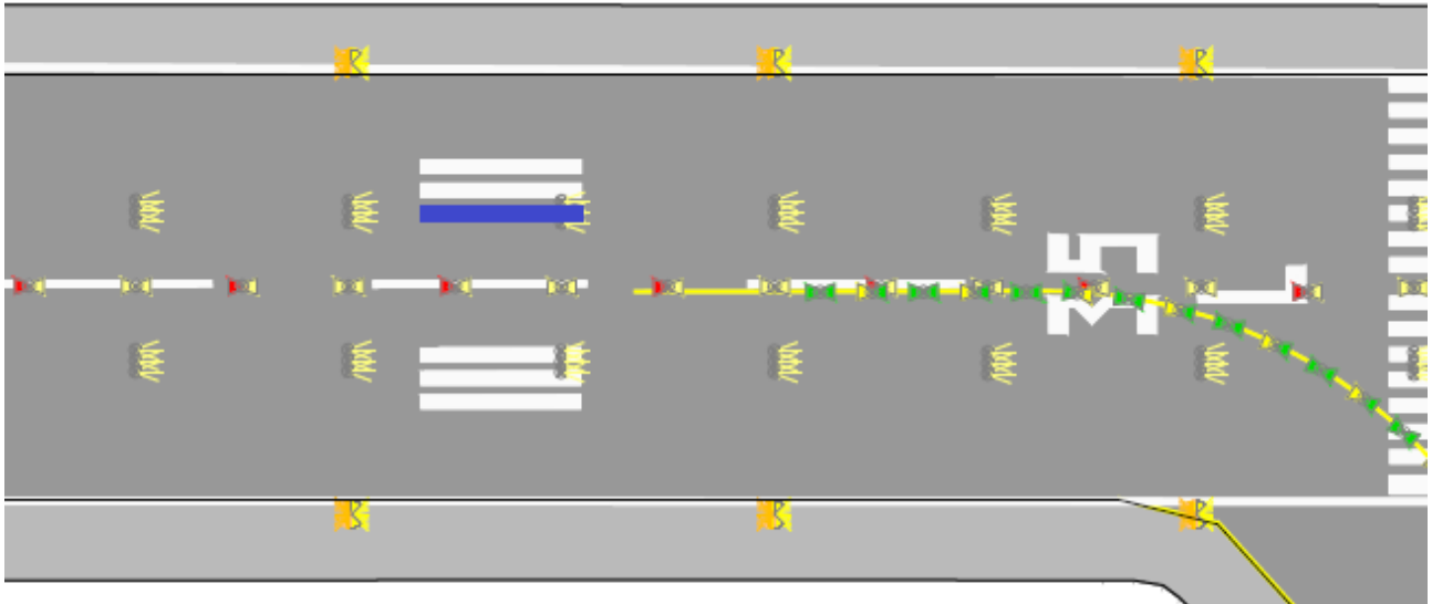
Figura 4.23: Fazzoletto di TDZ realizzato con microsfere Type I e pittura a solvente bianca sulla testata della pista 35L.
