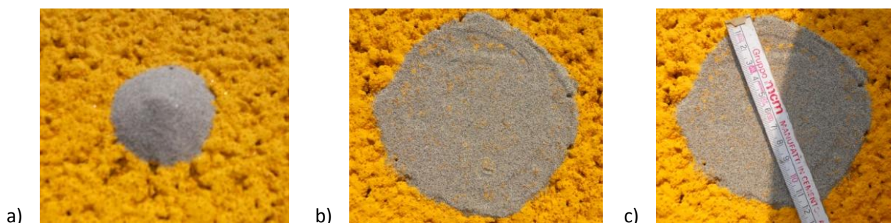
Figura 4.44: Fasi per l'esecuzione del metodo di altezza in sabbia: a) versamento della sabbia, b) spargimento in forma circolare e c) misura dei diametri dell'impronta.
