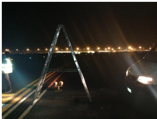
Figura 5.13: Configurazione per la simulazione della visibilità da cockpit.
