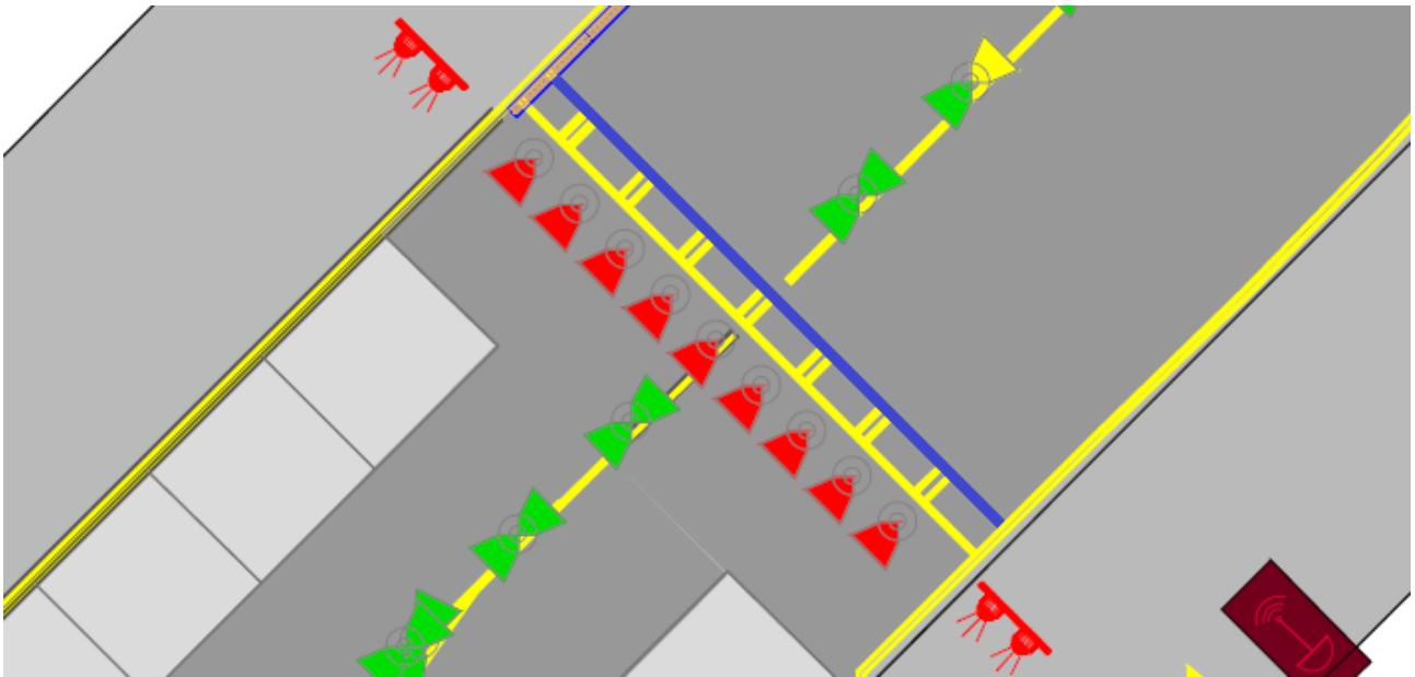
Figura 4.33: Linea continua di stop bar realizzata con vernice a solvente gialla e microsfere Type I.
