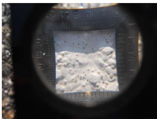
Figura 4.17: Verifica di inglobamento delle microsfele ICAO mediante lente di ingrandimento.
