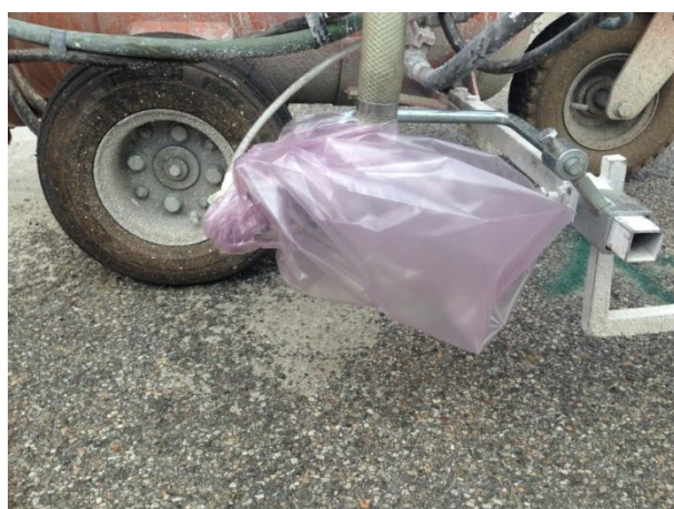
Figura 4.14: Posizionamento del sacchetto di raccolta delle microsfere erogate su 1 m 2 di superficie.
