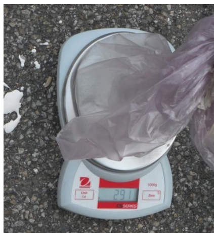
Figura 4.15: Determinazione del quantitativo di microsfere erogate su 1 m 2 di superficie.
