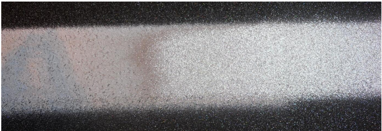
Figura 5.2: Punto di stacco tra microsfere Type I e microsfere Type III sulla viabilità ordinaria della zona Cargo Sud.
