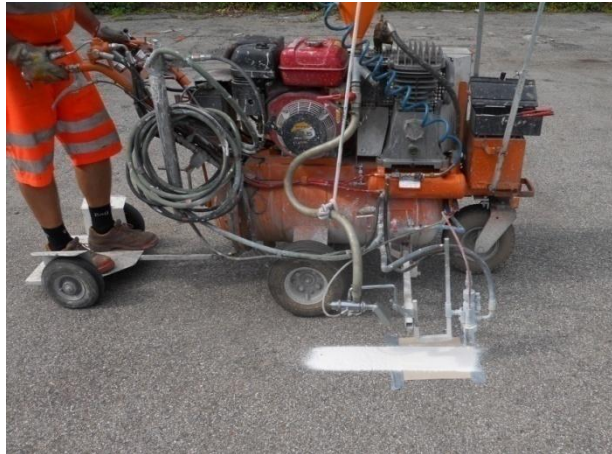
Figura 4.12: Fase di stesa della vernice su un cartoncino di peso noto.
