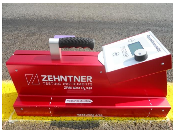
Figura 5.17: Retroriflettometro posizionato all'interno dell'area di test delimitata dal cordolo in silicone.
