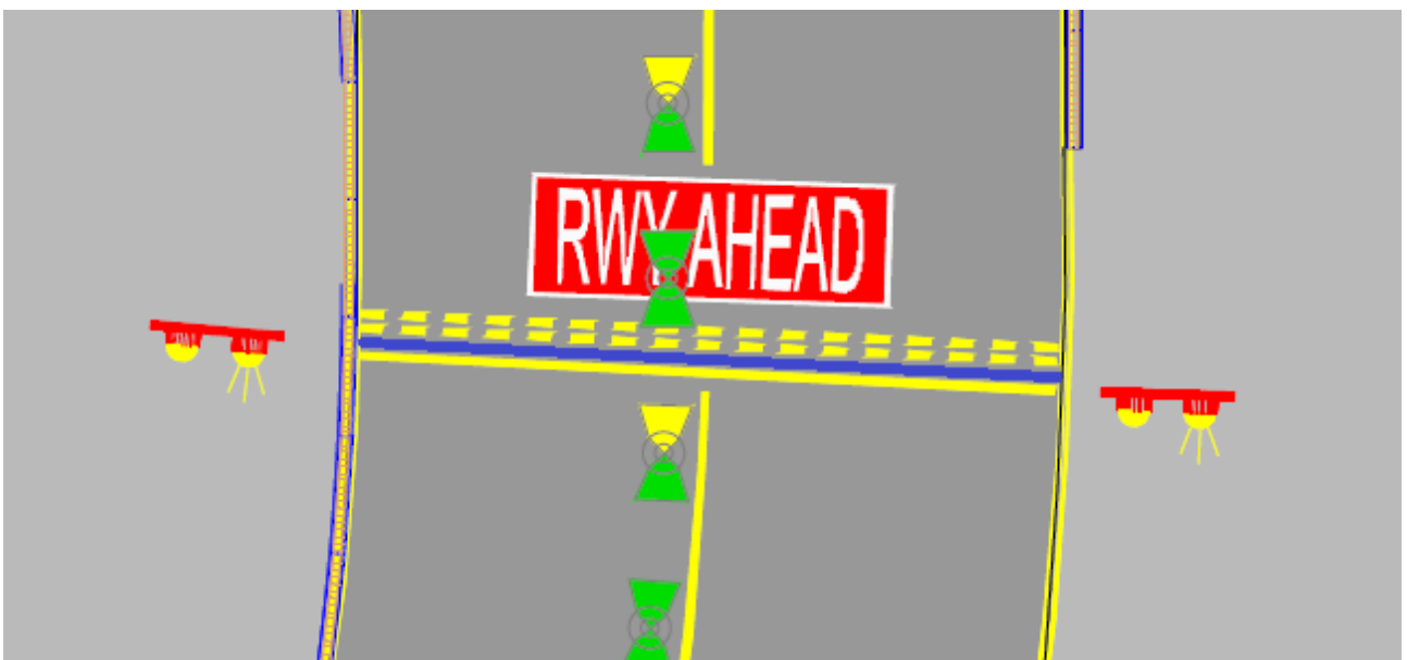
Figura 4.32: Linea continua di stop bar realizzata con vernice ad acqua gialla e microsferi ICAO.
