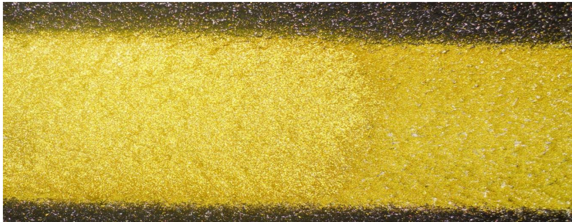
Figura 5.11: Punto di stacco tra microsfere Type III e miscela antiskid sulla centerline di taxiway della zona Cargo Sud.
