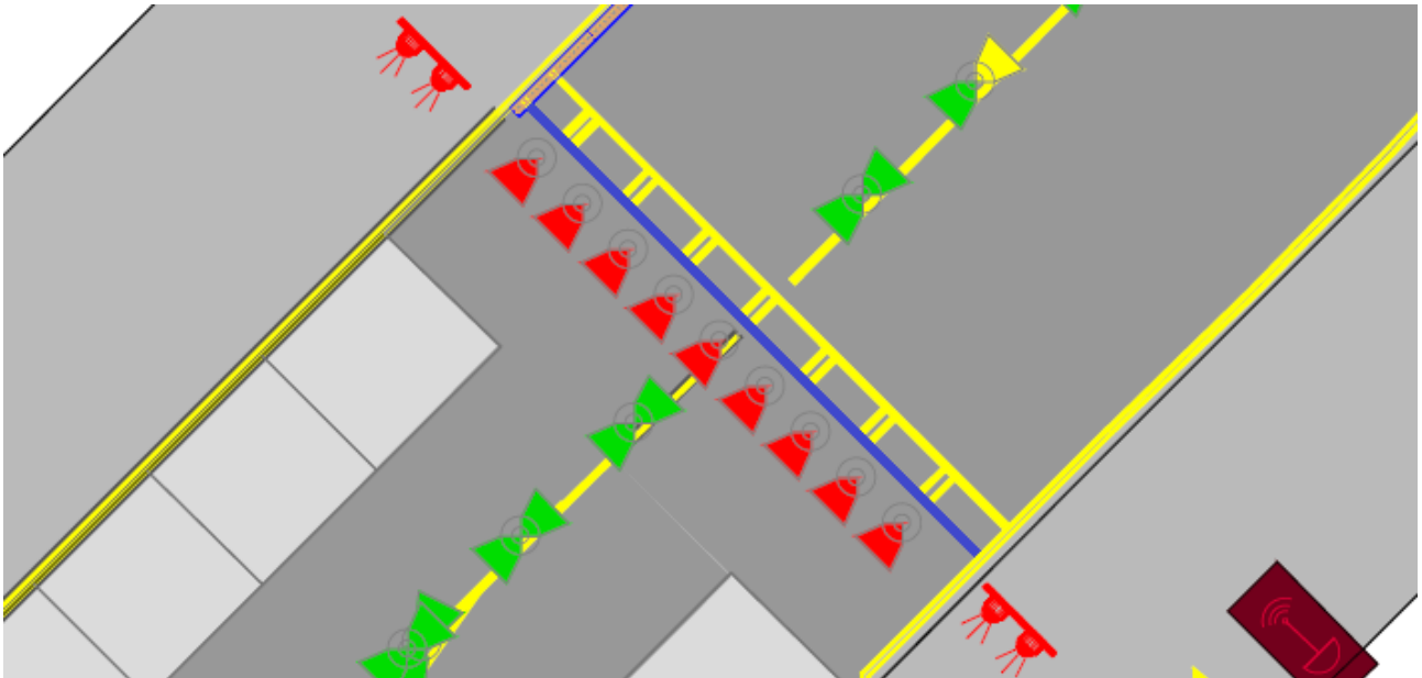
Figura 4.34: Linea continua di stop bar realizzata con vernice a solvente gialla e microsferi Type III.
