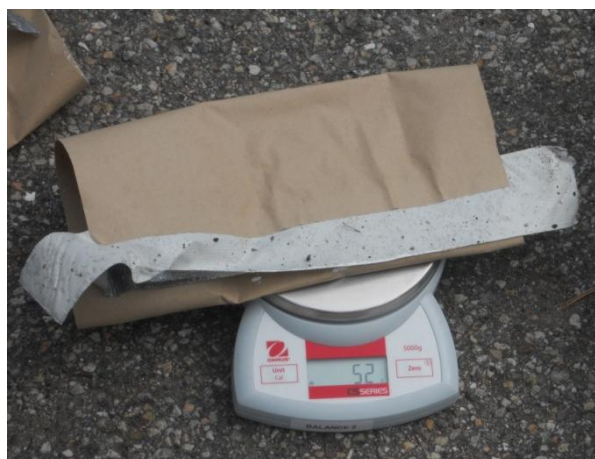
Figura 4.13: Determinazione del peso della pittura applicata sul cartoncino di peso noto.
