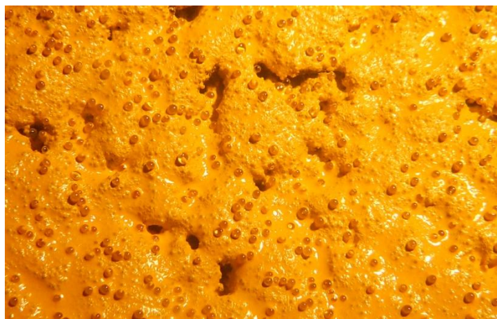
Figura 5.16: Scarso inglobamento delle microsfere rilevato sul raccordo Charlie-Alfa.
