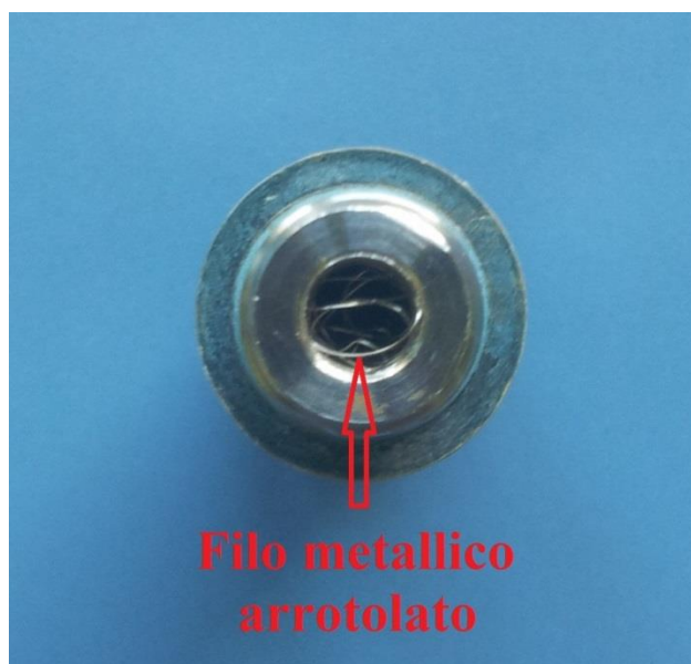
Figura 27: Dettaglio della spirale "rompigoccia".
