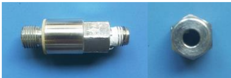
Figura 26: Condotto cilindrico per il carico del gas e dado forato dotato di setto.
