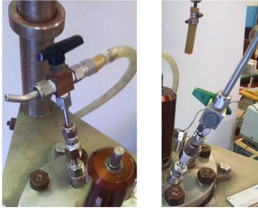
Figura 22: Valvola di sfogo e connettore al manometro, valvola di carico del fango.
