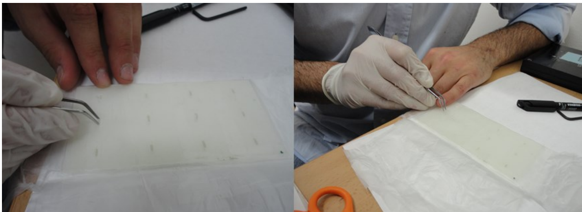
Figura 19: Inserimento TLD in supporto per fantoccio
