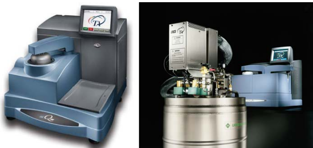
Figura 4.18 Sistema DSC utilizzato: unità DSC-Q100 TA Instruments (sinistra) e Dewar LNCS per lo stoccaggio di Azoto (destra)
