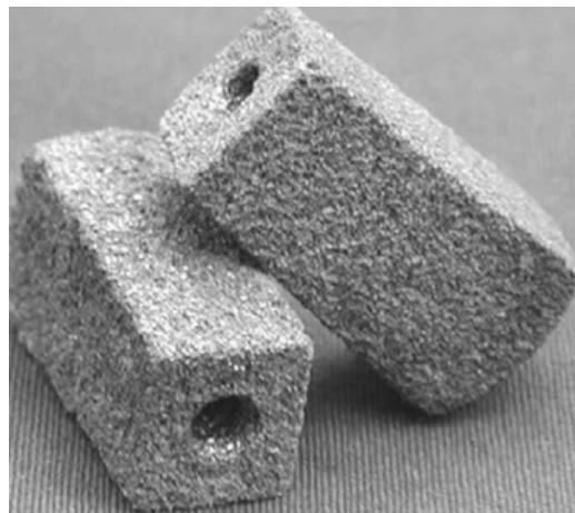
Figura 1.30 Impianto NiTi commercialmente disponibile prodotto per sinterizzazione (self-propagating high-temperature synthesis – SHS) (A. Bansiddhi, 2008)
