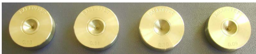
Figura 4.3 Serie di filiere impiegate per ridurre la sezione del filo con sequenza di diametri: 130 \mu m, 110 \mu m, 100 \mu m, 90 \mu m
