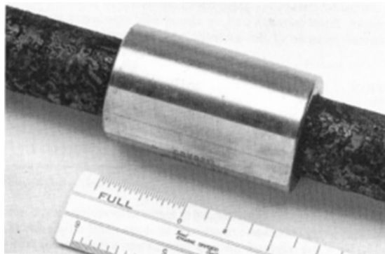
Figura 1.19 Manicotto di NiTiFe montato su tubo di acciaio (ing.unitn.it)
