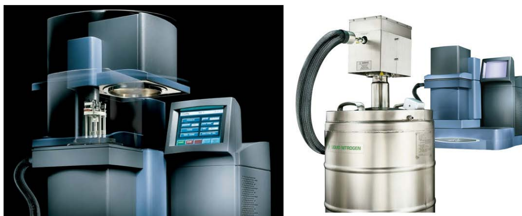
Figura 4.19 Sistema DMA utilizzato: unità DMA-Q800 TA Instruments (sinistra) e Dewar GCA per lo stoccaggio di Azoto (destra)
