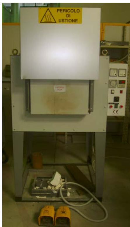
Figura 4.4 Forno a muffola utilizzato per eseguire il trattamento termico convenzionale
