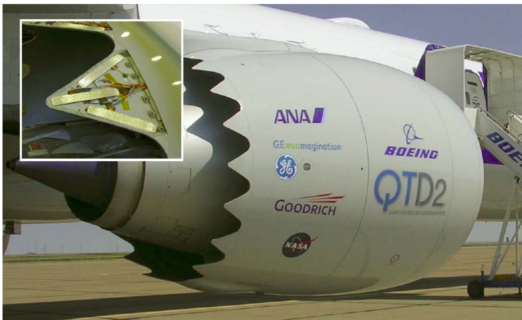
Figura 1.20 Chevron: dispositivo in SMA per la riduzione del rumore nei motori jet, sviluppato da Boeing, General Electric e NASA (B. Herkes, 2006)
