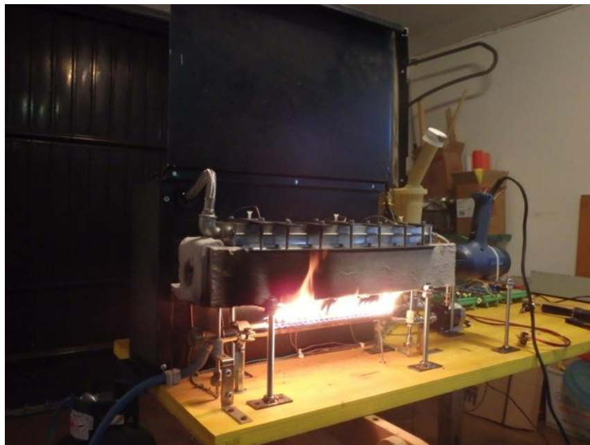
Fig. 66 Moduli termoelettrici e generatore in funzione
