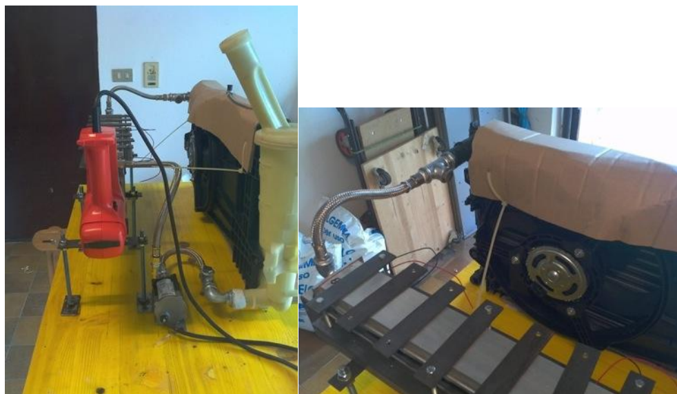
Fig.52 Particolare della pompa di ricircolo e del dissipatore
