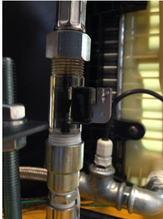
Fig.54 Particolare del sensore di portata FLOWMETER VISIO2000 e del sensore di temperatura acqua
